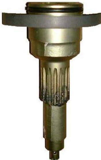
Positionner et maintenir le palier inférieur 300.2 sur l'axe 210 tout en insérant le palonnier 59-26 avec marquage du palonnier côté interface d'accouplement robinet.
