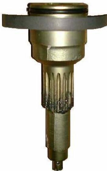
Colocar y sujetar el cojinete inferior 300.2 en el eje 210, insertando la biela 59-26 con la marca de la biela del lado interfaz de acoplamiento de la válvula.
