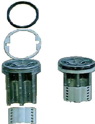
Die Dichtringe 412.3, die Gleitschuhe 81.68 und die Kolbenringe 593 in die Kolben 595 einlegen.
