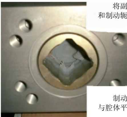
将副-组件轴插入腔体 103 中，确保槽和制动靴 59—26 接触
