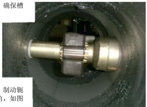
制动靴在腔体中的棱角位置：制动靴与腔体平行，与轴的端面成 45° 角，如图
