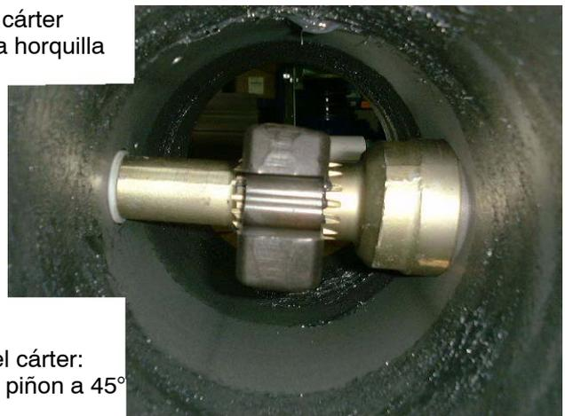
Posición angular de la horquilla en el cárter: paralela al cárter y cuadrado del eje piñon a 45° según las fotos adjuntas.
