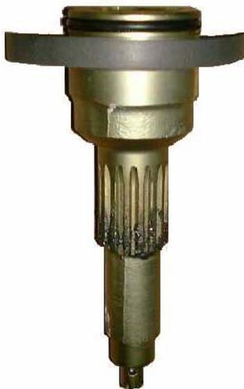
Situar y poner el casquillo inferior 300.2 sobre el eje piñon 210 insertando la horquilla 59-26 con la marca de la horquilla lado interfaz de acoplamiento de la válvula.
