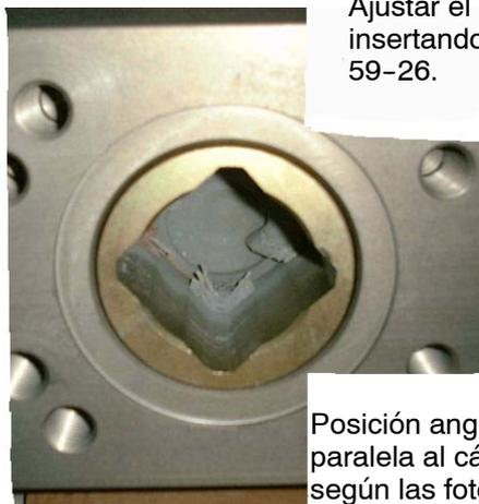
Ajustar el sub-conjunto eje en el cárter insertando las acanaladuras en la horquilla 59-26.
