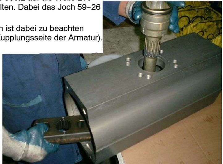
Die Baugruppe Welle in das Gehäuse 103 einpressen. Dabei muss deren Keilnutverzahnung in die des Jochs 59-26 eingreifen.
