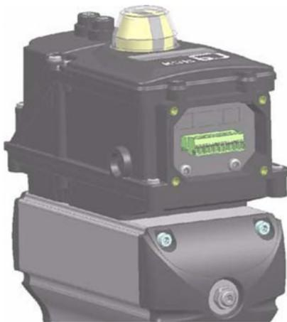
Für den Zugang zu den Anschlussklemmenbrettern die 4 TORX- Schrauben (T20) von der Anschluss- haube lösen.
