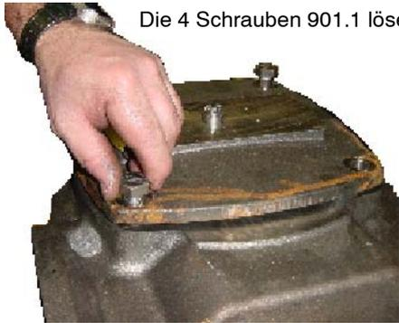
Die 4 Schrauben 901.1 lösen.
