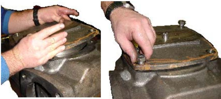
Gehäusedeckel vorsichtig aufsetzen. Dabei Dichtringe und Führungsband nicht beschädigen.
