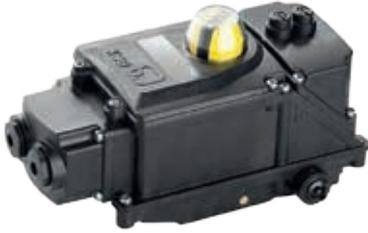
AMTRONIC ist eine Auf/Zu-Steuereinheit zum Aufbau auf Stellantriebe der KSB-Baureihe ACTAIR/DYNACTAIR mit direkter Steuerluftversorgung, auf Schwenkantriebe mit VDI/VDE 3845-Schnittstelle oder auf Hubantriebe nach NAMUR.
