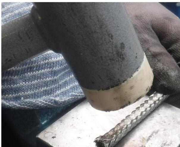
Fig. 21: Compressione del cordone di tenuta
