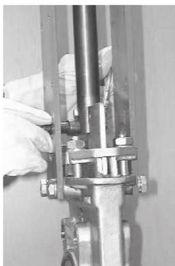
Fig. 13: Stelo saliente: allentamento delle viti
