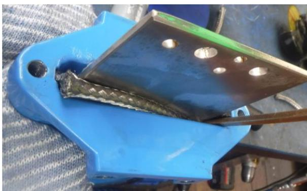
Fig. 22: Montaggio del cordone di tenuta
