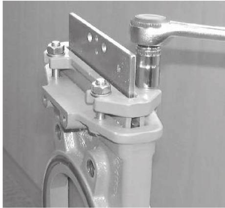
Fig. 23: Apretar la brida del prensaestopas
