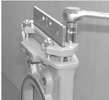
**Fig. 14:** Aflojar las tuercas de la brida del prensaestopas
