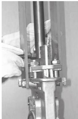
Abb. 13: steigende Spindel: Schrauben lösen
