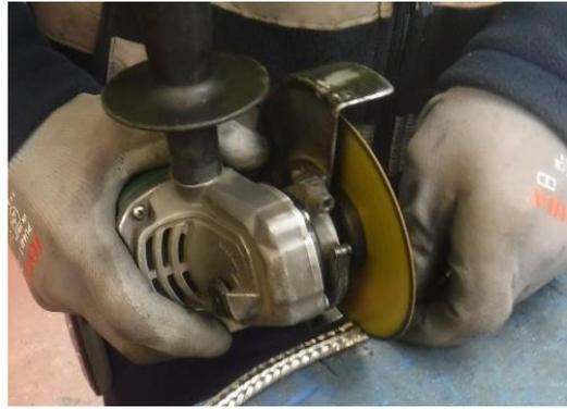
Abb. 20: Dichtschnur schneiden
