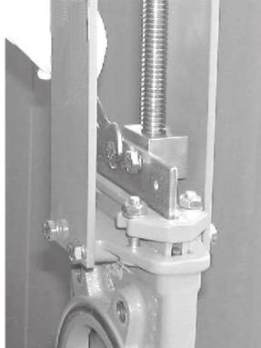
Abb. 12: nichtsteigende Spindel: Schrauben lösen
