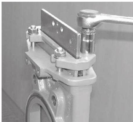
Abb. 14: Muttern der Stopfbuchsbrille lösen
