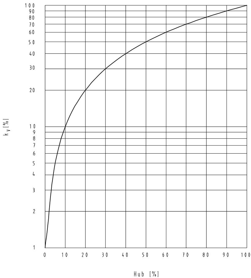
$k_{vS}$  - Werte in  $m^3/h$  ( $k_v$  - Werte bei Hub = 100%)
