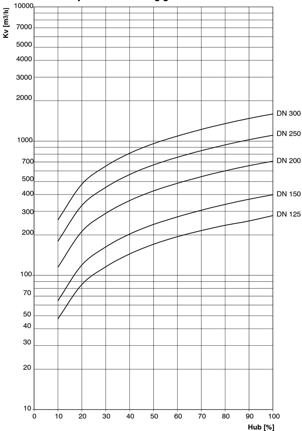
**$K_{Vs}$ -Werte in  $m^3/h$  ( $K_V$ -Werte bei Hub = 100 %)**
