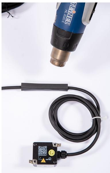
Fig. 12: Riscaldamento della guaina termoretraibile
