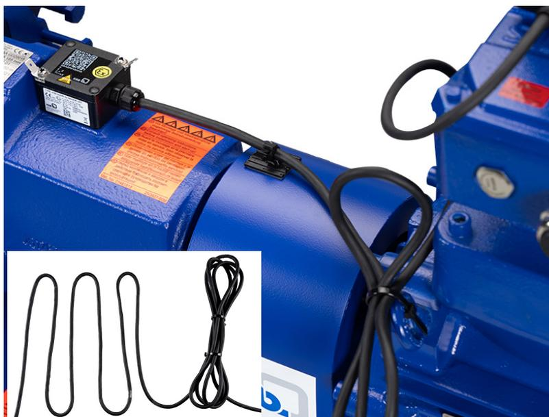
**Fig. 14:** Posa del cavo di collegamento elettrico formando delle serpentine
