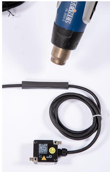
Abb. 12: Schrumpfschlauch erwärmen
