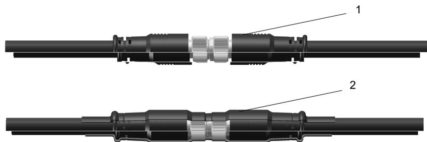
**Abb. 11:** Schrumpfschlauch installieren
