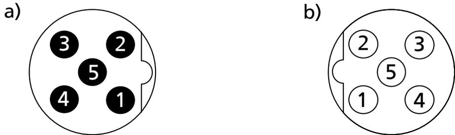
III. 6: Utilisation des broches : a) Vue sur connecteur mâle M12 b) Vue sur connecteur femelle M12
