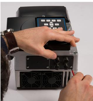
Abb. 4: Feldbusmodul befestigen
