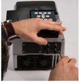
**Abb. 4:** Feldbusmodul befestigen
