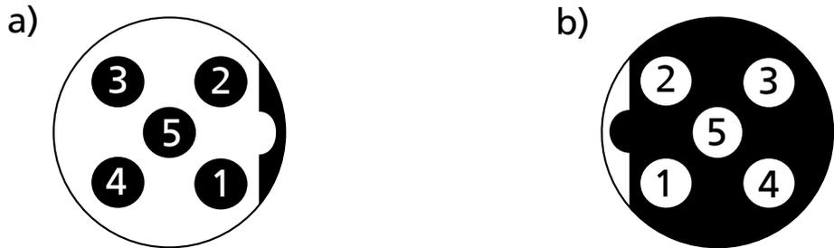
III. 6: Affection des contacts : a) vue sur connecteur mâle M12, b) vue sur connecteur femelle M12
