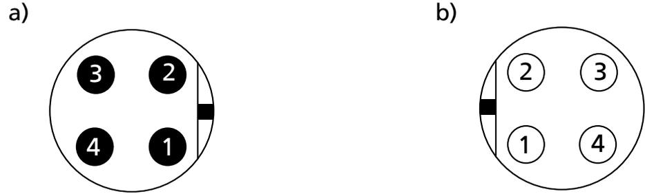
Abb. 6: Pinbelegung: a) Polbild M12-Stecker, b) Polbild M12-Buchse
