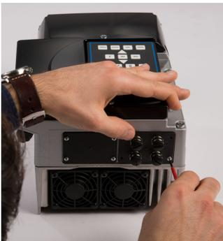
**Abb. 4:** Feldbusmodul befestigen
