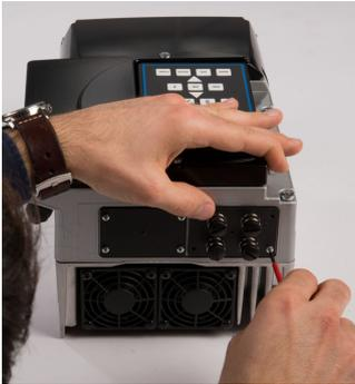
**Abb. 4:** Feldbusmodul befestigen
