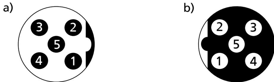
Abb. 7: Pinbelegung: a) Polbild M12-Stecker, b) Polbild M12-Buchse
