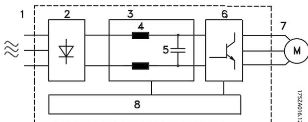
**Ilustración 1.3** Diagrama de bloques de convertidor de frecuencia
