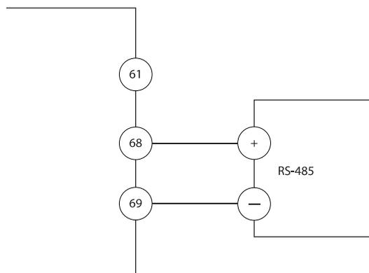
Ilustración 4.11 Diagrama de cableado de comunicación serie
