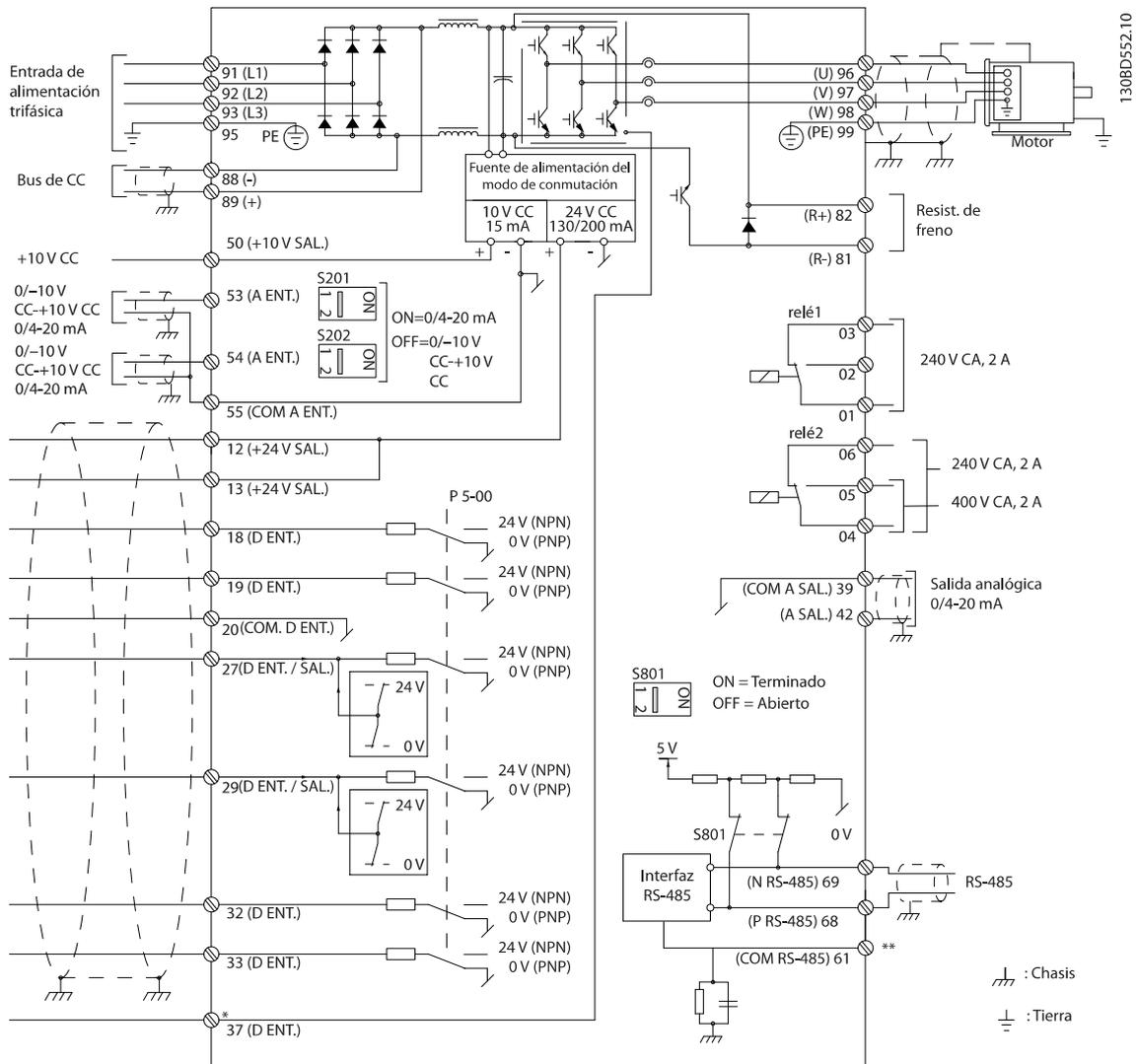
Ilustración 4.1 Esquema básico del cableado
