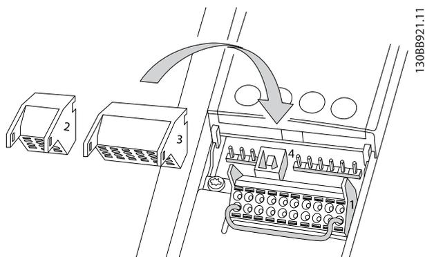
Ilustración 4.7 Ubicación de los terminales de control
