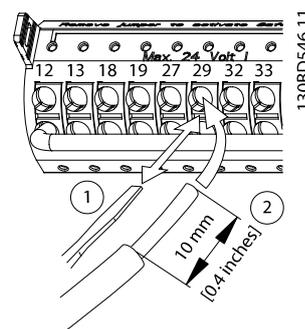
Ilustración 4.9 Conexión de los cables de control
