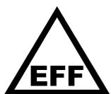
O tempo de operação da bomba nas diferentes faixas de operação são abrangidos como perfil de carga e armazenados em uma memória não-volátil (protegida contra falta de energia). O ícone de eficiência energética exibido no display indica a presença de um potencial de otimização.
