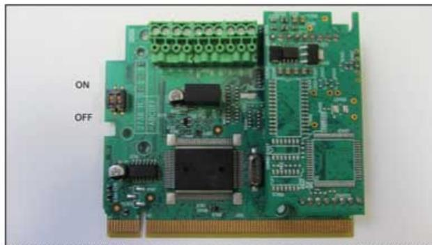
**Abb. 1:** DIP-Schalter Abschlusswiderstände
