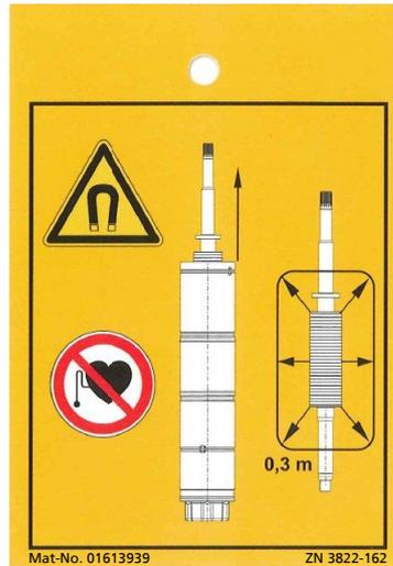
**Abb. 2:** Waraufkleber, der bei Rücksendung auf den Motor geklebt werden muss. Ist dieser nicht mehr vorhanden, die nächstgelegenen KSB-Serviceeinrichtung kontaktieren, um ein Ersatzschild zu erhalten.
