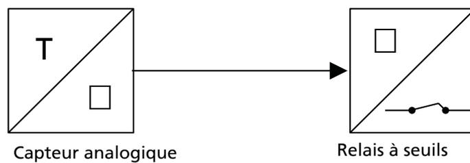
III. 40: Traitement des signaux d'un capteur analogique - relais à seuils à l'exemple de la surveillance de la température : fonctionnement conforme
