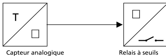
III. 41: Traitement des signaux d'un capteur analogique - relais à seuils à l'exemple de la surveillance de la température : incident
