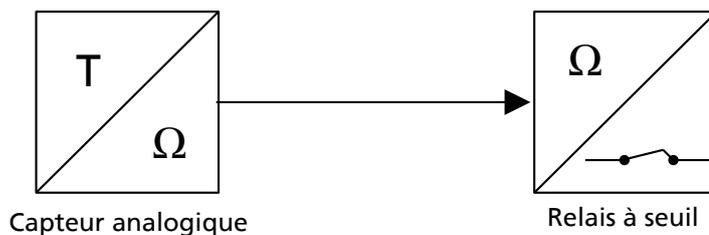
III. 35: Traitement des signaux d'un capteur analogique - relais à seuil à l'exemple de la surveillance de la température : fonctionnement conforme
