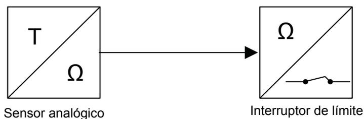
**Fig. 35:** Uso de la señal del sensor analógico; ejemplo de interruptor de límite con control de temperatura: uso adecuado
