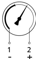
**Fig. 29:** Asignación de conexiones del manómetro de contacto
