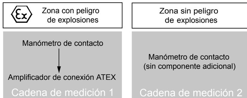
Fig. 30: Ejecución de la cadena de medición
