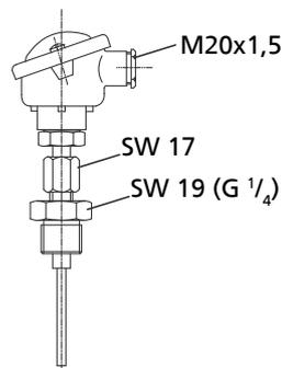
**Fig. 3:** PT100 resistance thermometer (Ksb-4,13,xx,01)
