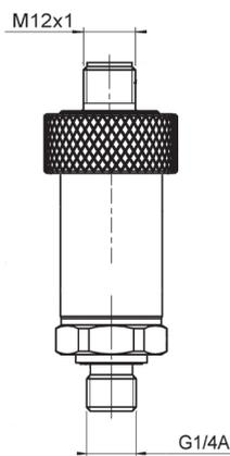
**Fig. 24:** Pressure switch
