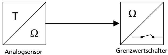
**Abb. 35:** Signalverarbeitung Anlogsensor - Grenzwertschalter am Beispiel Temperaturüberwachung: Bestimmungsgemäßer Betrieb
