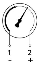
Abb. 29: Klemmenbelegung Kontaktmanometer
