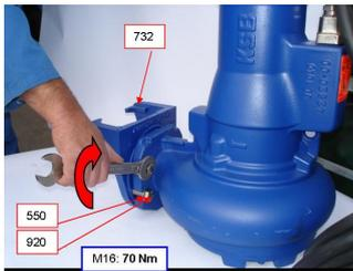
**Abb. 13:** Halterung montieren bei Seilführung, 1-Stangenführung und Bügelführung
