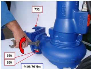
Fig. 14: Montaggio supporto con guida a 2 barre
