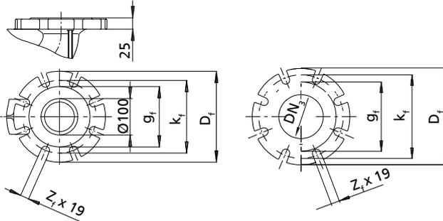
Abmessungen Krümmerflansch DN<sub>3</sub> [mm]
