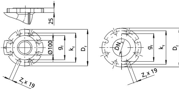
Abmessungen Krümmmerflansch DN<sub>3</sub> [mm]
