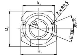
Abmessungen Pumpenflansch [mm]
