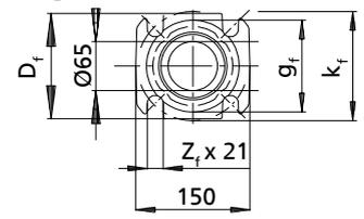
**Abmessungen Krümmmerflansch DN<sub>3</sub> [mm]**
