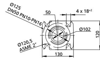
**Amarex N 50 - stationäre Aufstellung - Seil-, 1-Stangen- und Bügelführung, schräge Halterung**
