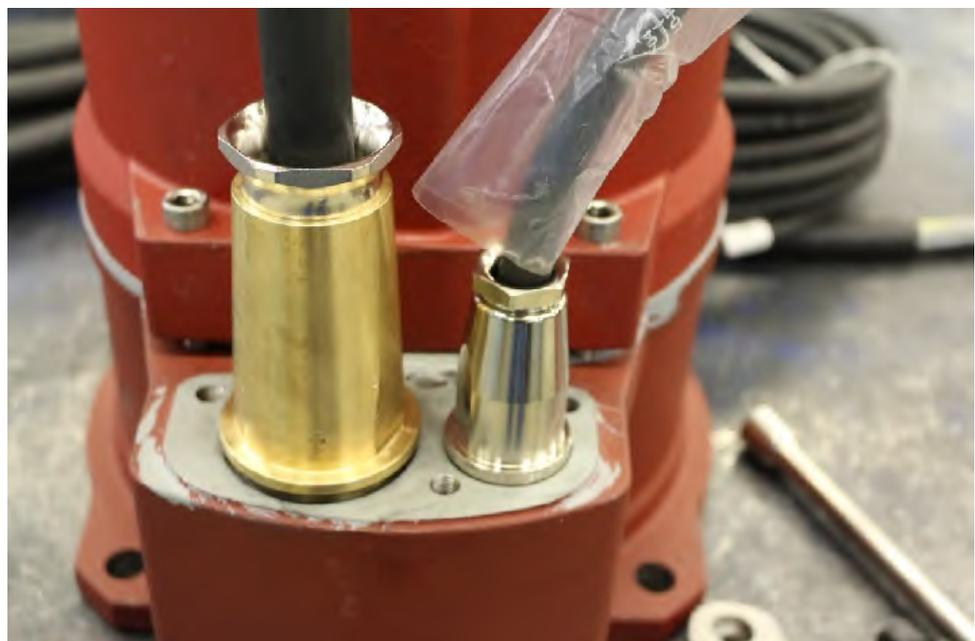
Abb. 65: Kabelbaum in Lagergehäuse einführen
