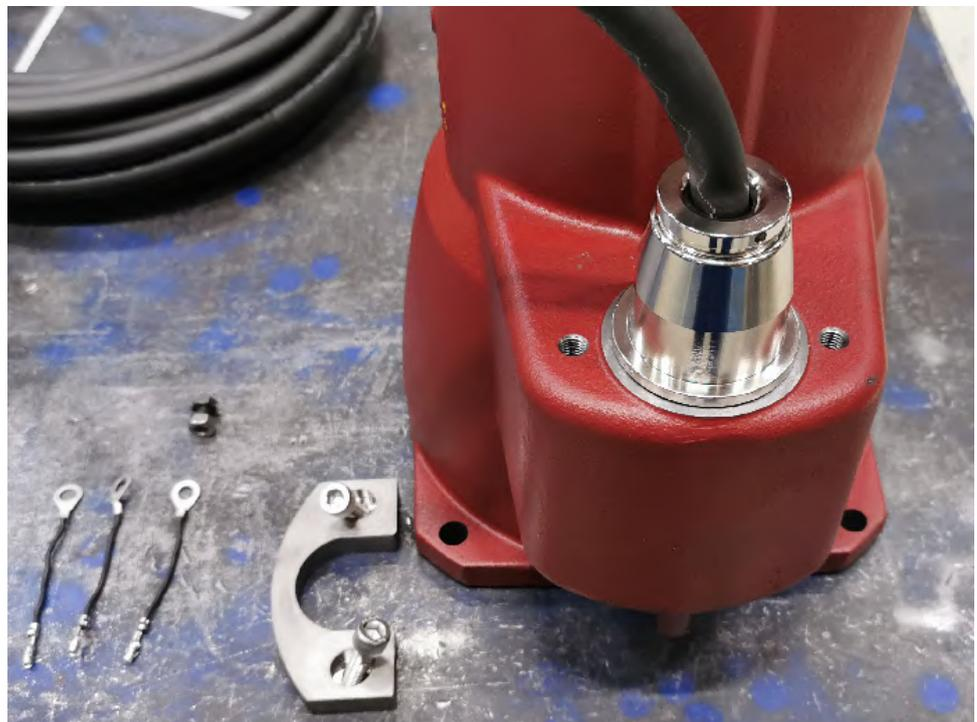
**Abb. 33:** Leitungseinführung einsetzen
