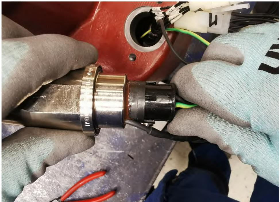
Abb. 11: Leitungseinführung und Buchsenkontaktteil zusammenstecken
