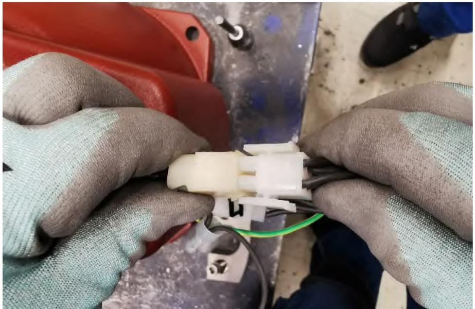
**Abb. 9:** 2 Steckerverbindungen zusammenstecken
