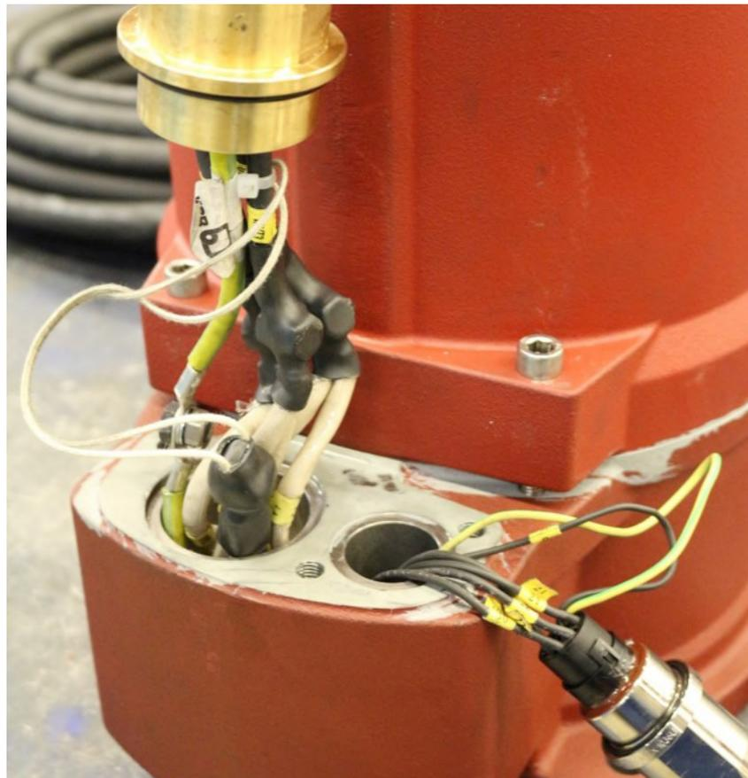
**Abb. 60: Beide Leitungseinführungen und Kabelbäume herausnehmen**
