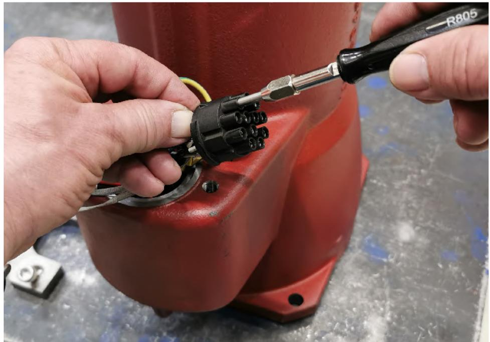
Abb. 23: Variante mit runden Kontakten: Rundkontakt lösen
