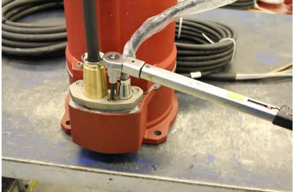
Abb. 66: Klemmstück montieren
