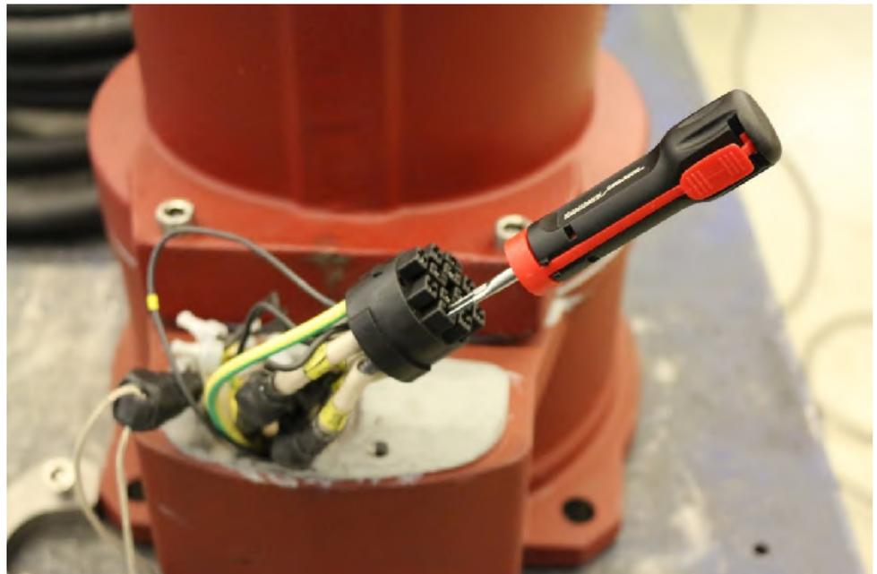
**Abb. 43:** Variante mit flachen Kontakten: Messerkontakt lösen
