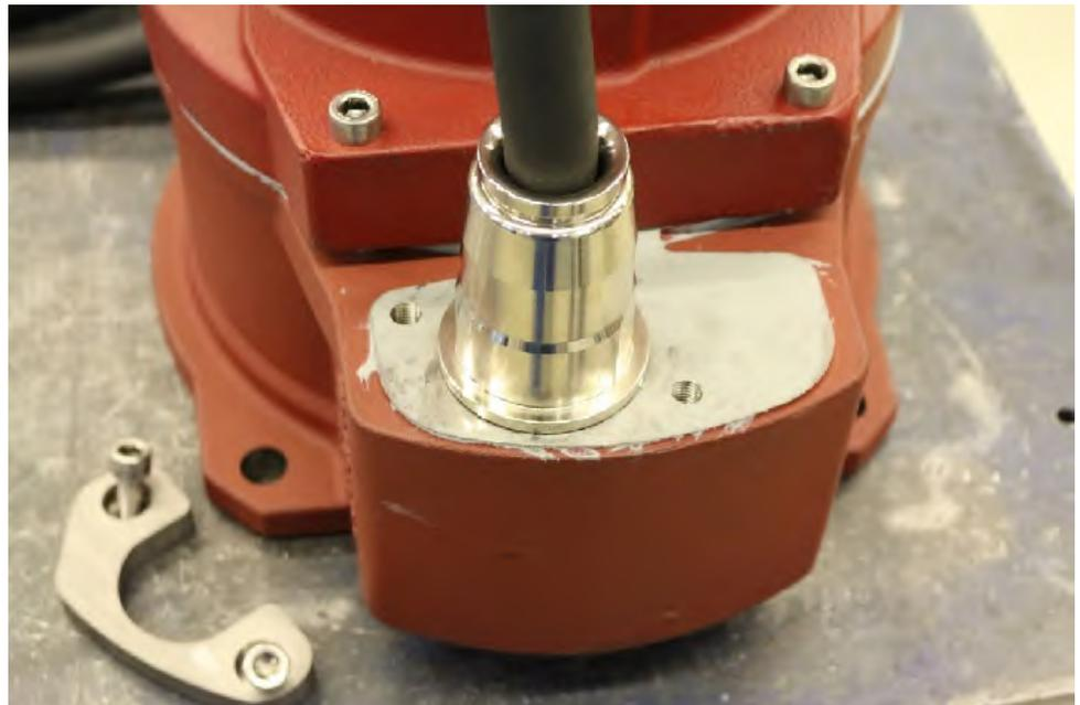
Abb. 52: Leitungseinführung einsetzen
