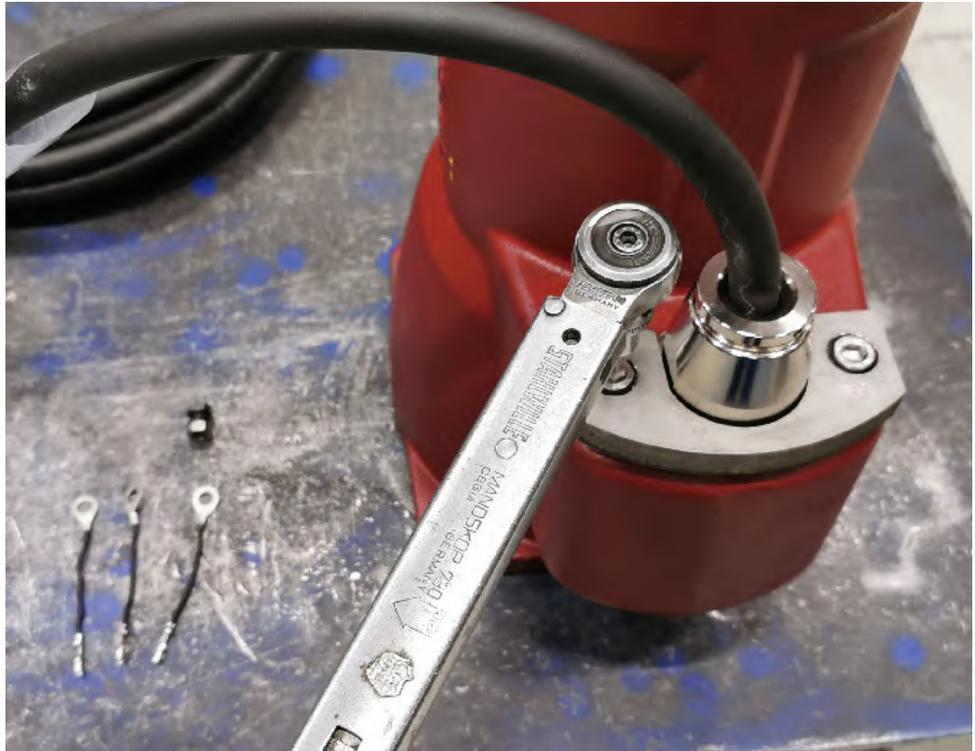
Abb. 34: Klemmstück montieren
