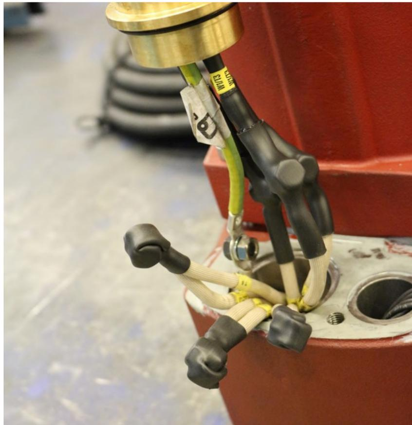
Abb. 64: Schrumpfschläuche verschrumpfen
