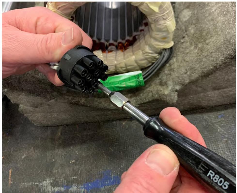
**Abb. 44:** Variante mit runden Kontakten: Rundkontakt lösen
