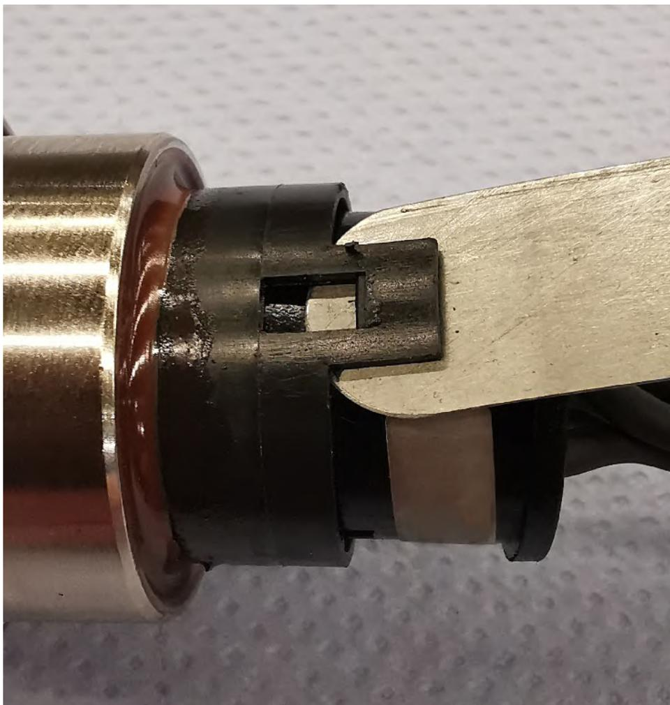
Abb. 61: Leitungseinführung trennen
