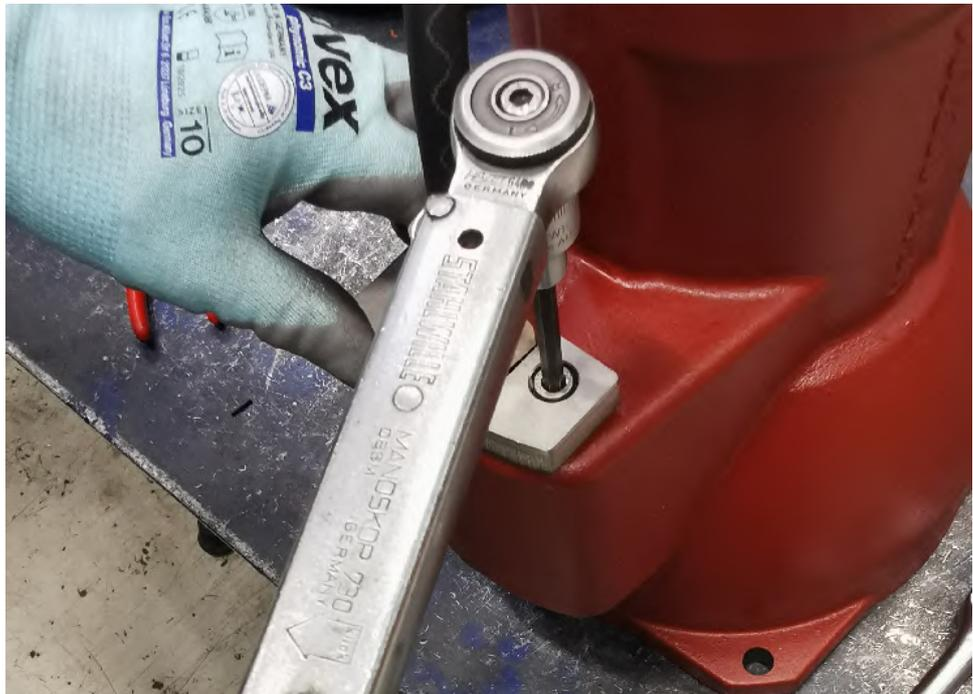
Abb. 3: Klemmstück demontieren
