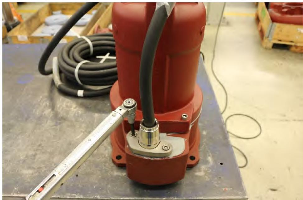
**Abb. 40:** Klemmstück demontieren
