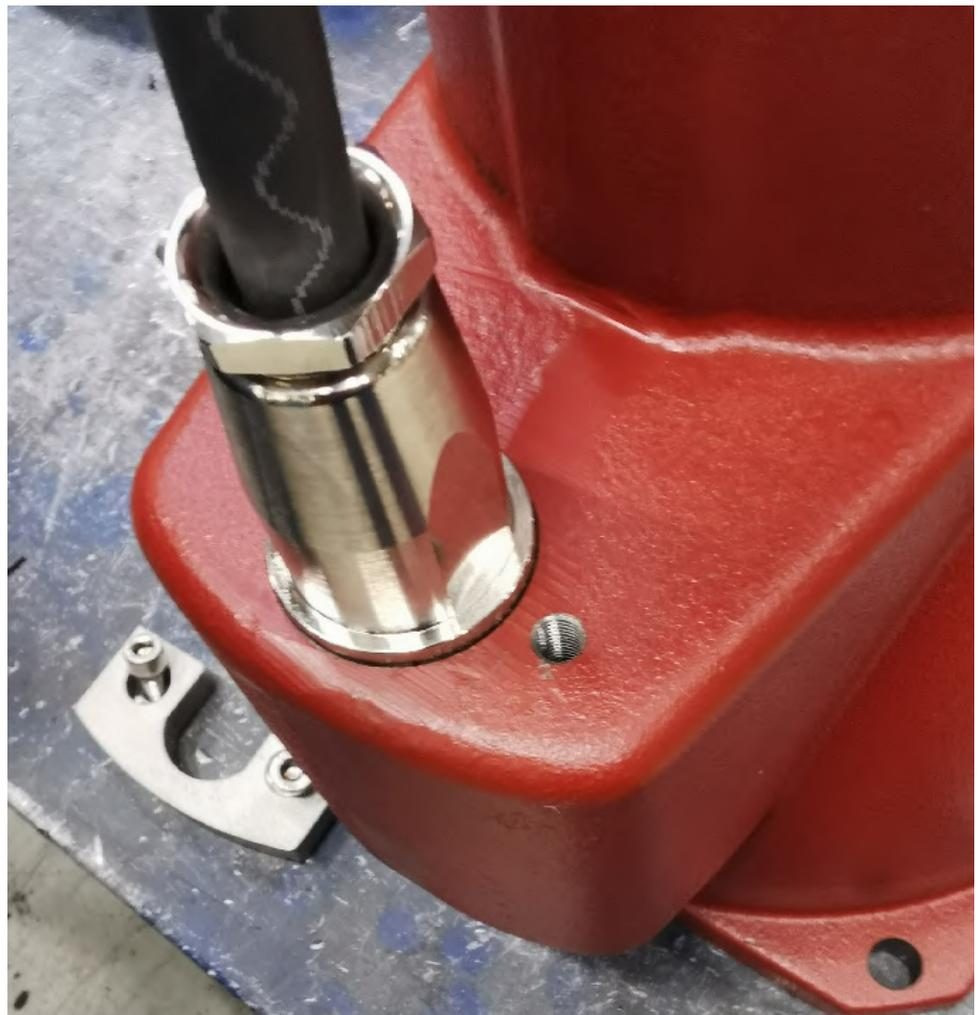
Abb. 13: Leitungseinführung in Lagergehäuse einsetzen
