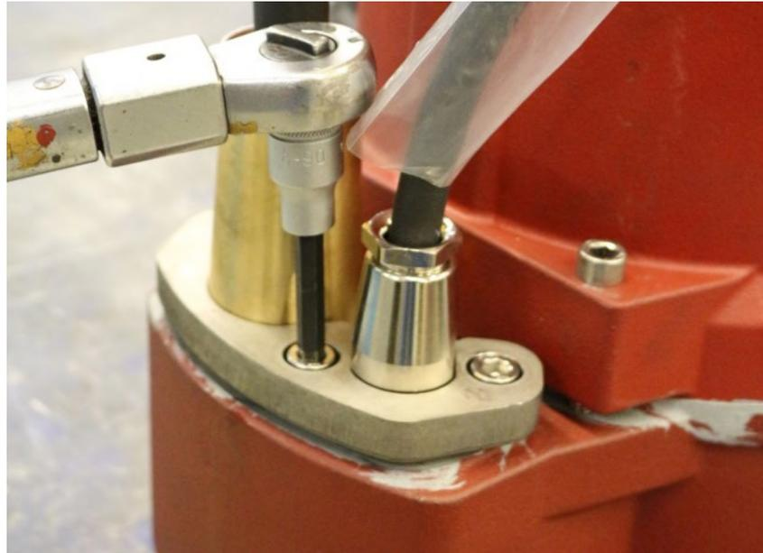
**Abb. 59: Klemmstück demontieren**
