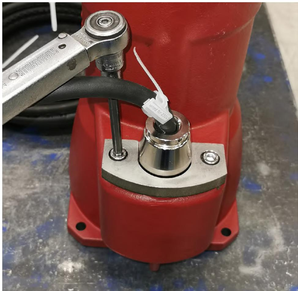
**Abb. 19:** Klemmstück demontieren
