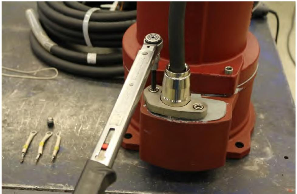
**Abb. 53:** Klemmstück montieren
