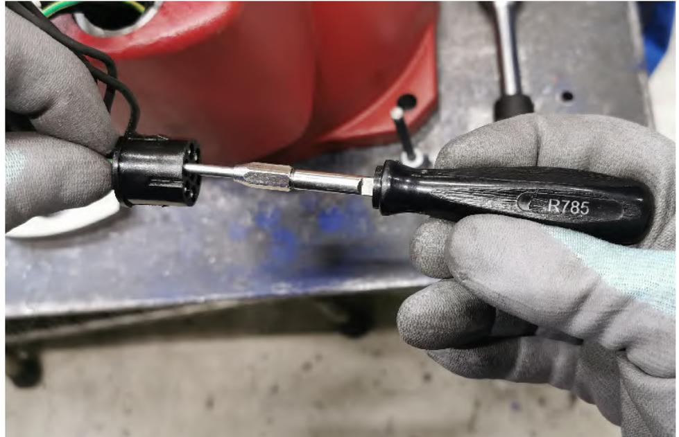
**Abb. 6:** Schutzleiter entfernen
