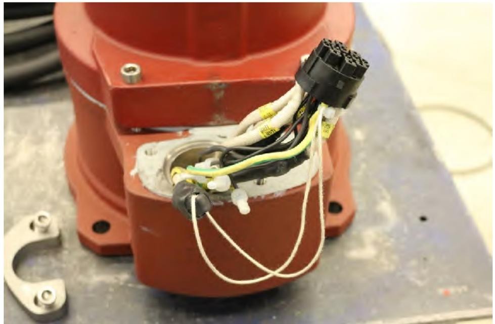
**Abb. 41:** Leitungseinführung und Kabelbaum herausnehmen
