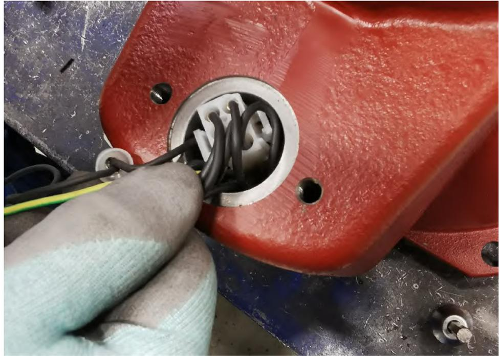
Abb. 12: Steckersystem ins Lagergehäuse einführen
