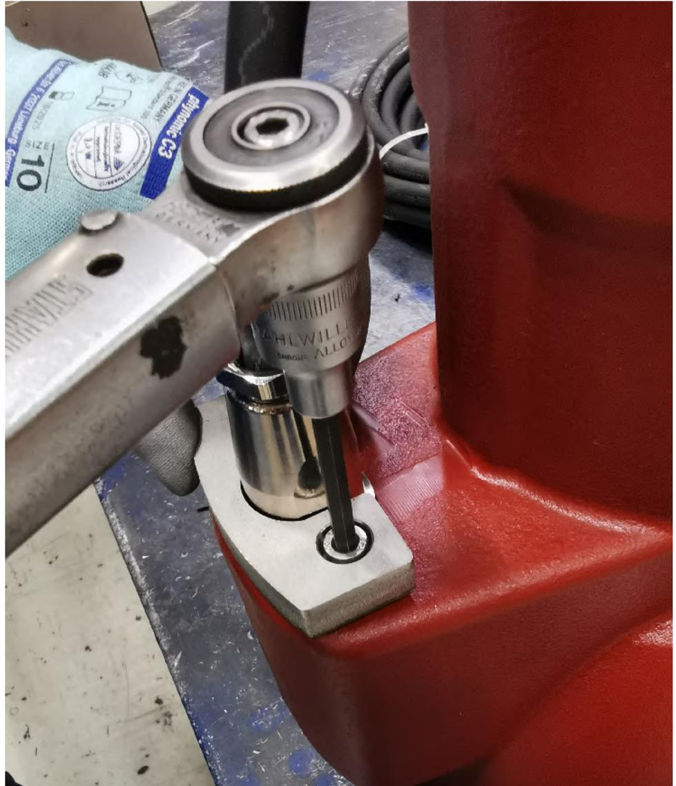
Abb. 14: Klemmstück montieren
