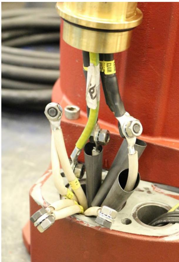
Abb. 63: Schrumpfschläuche aufziehen
