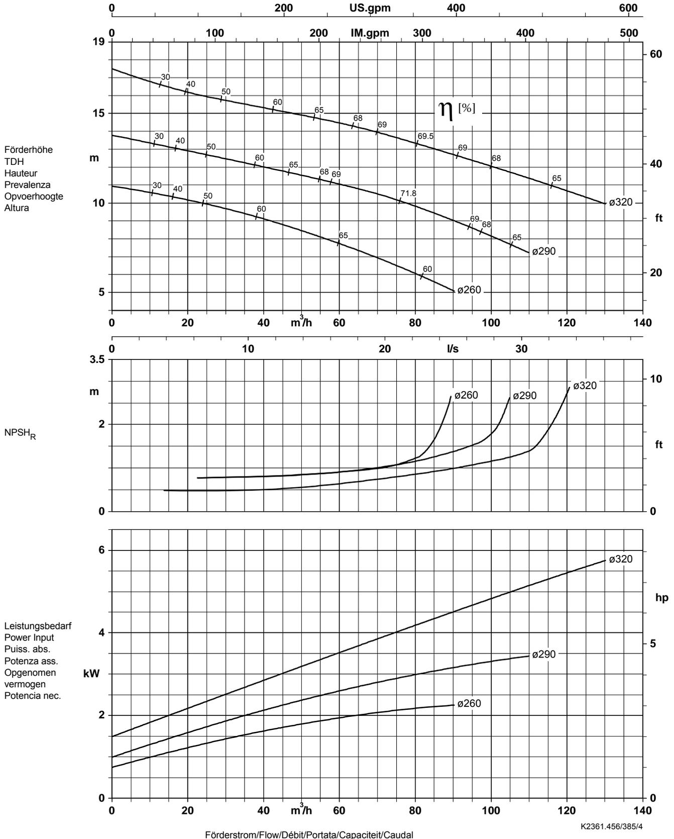
Laufradaustrittsbreite/Impeller outlet width/Largeur à la sortie de la roue 49 x 44 mm
