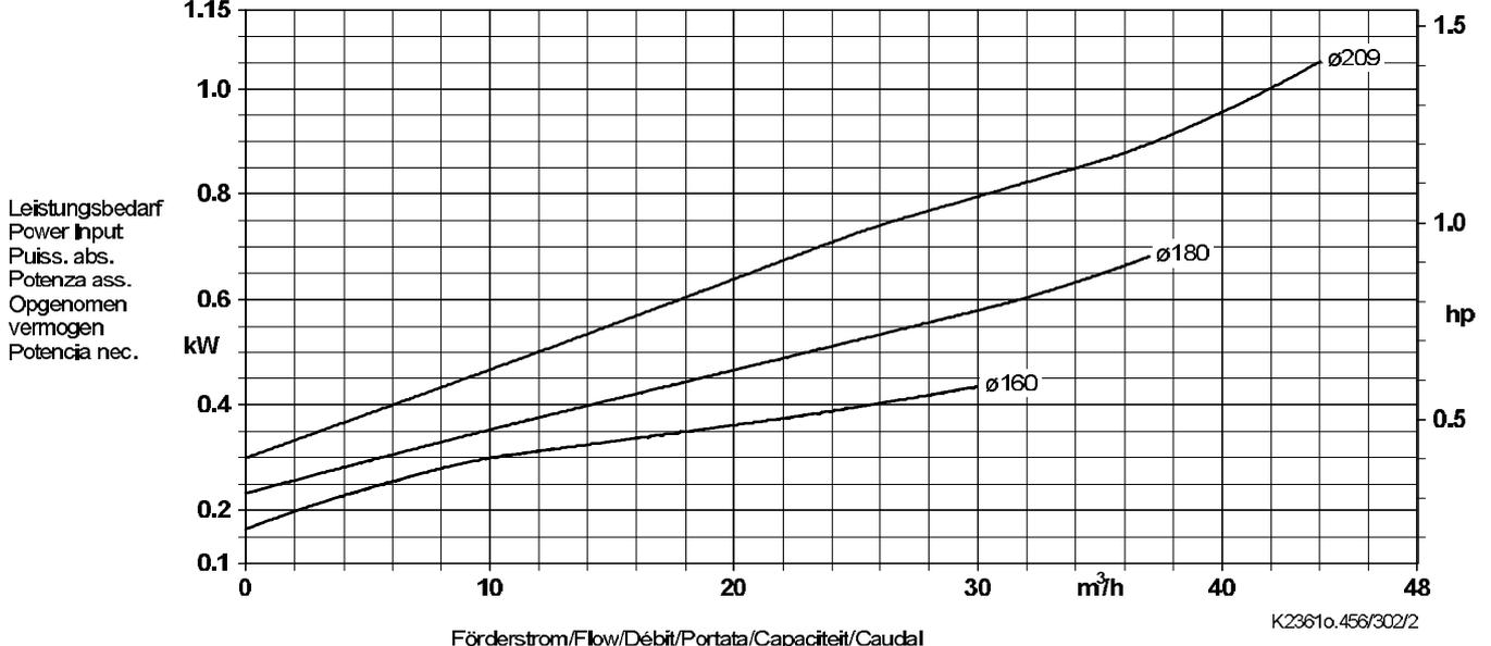
Lauftradaustrittsbreite/Impeller outlet width/Largeur à la sortie de la roue 30,0 mm
