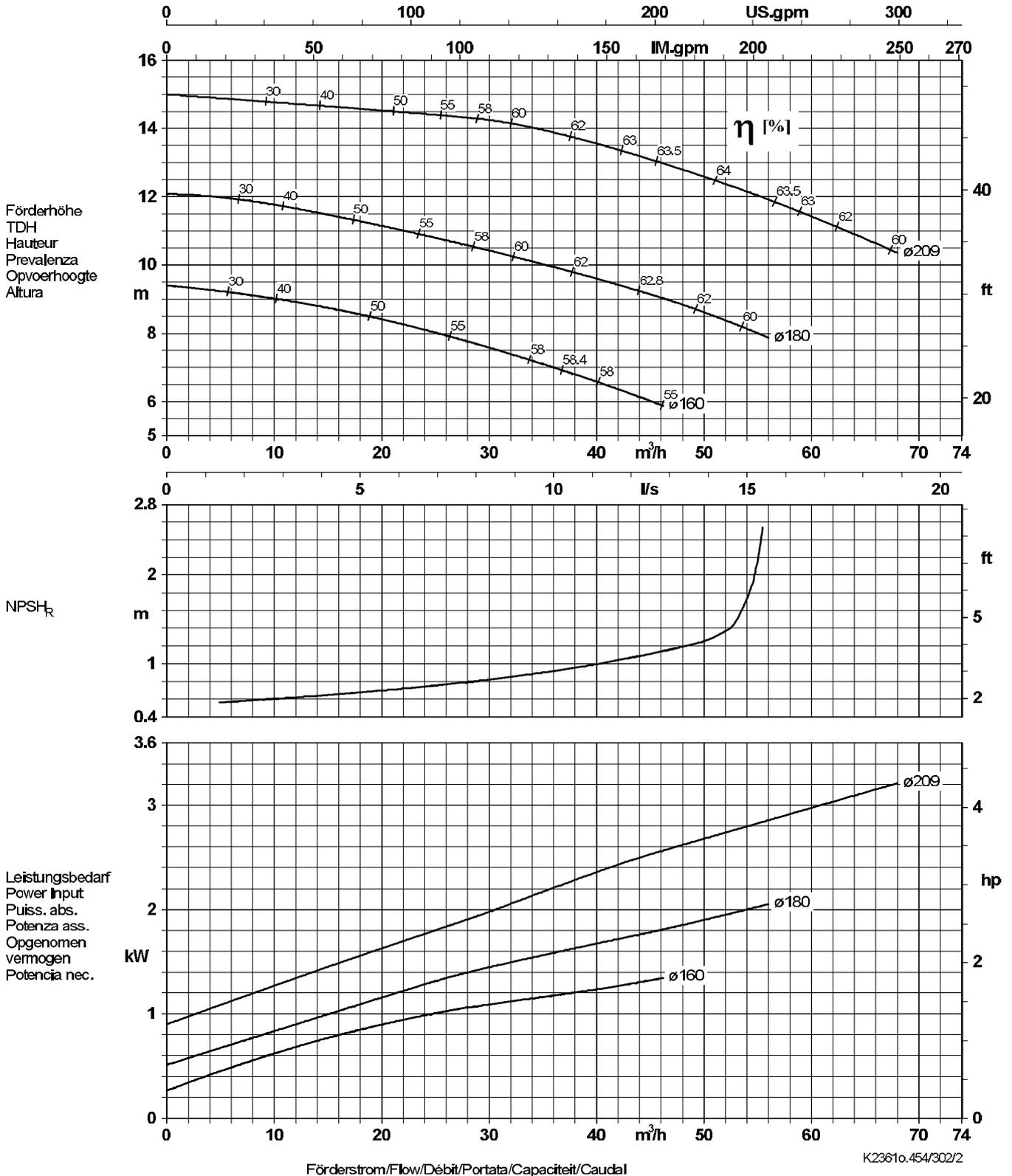
Lauftradaustrittsbreite / Impeller outlet width / Largeur à la sortie de la roue 30,0 mm
