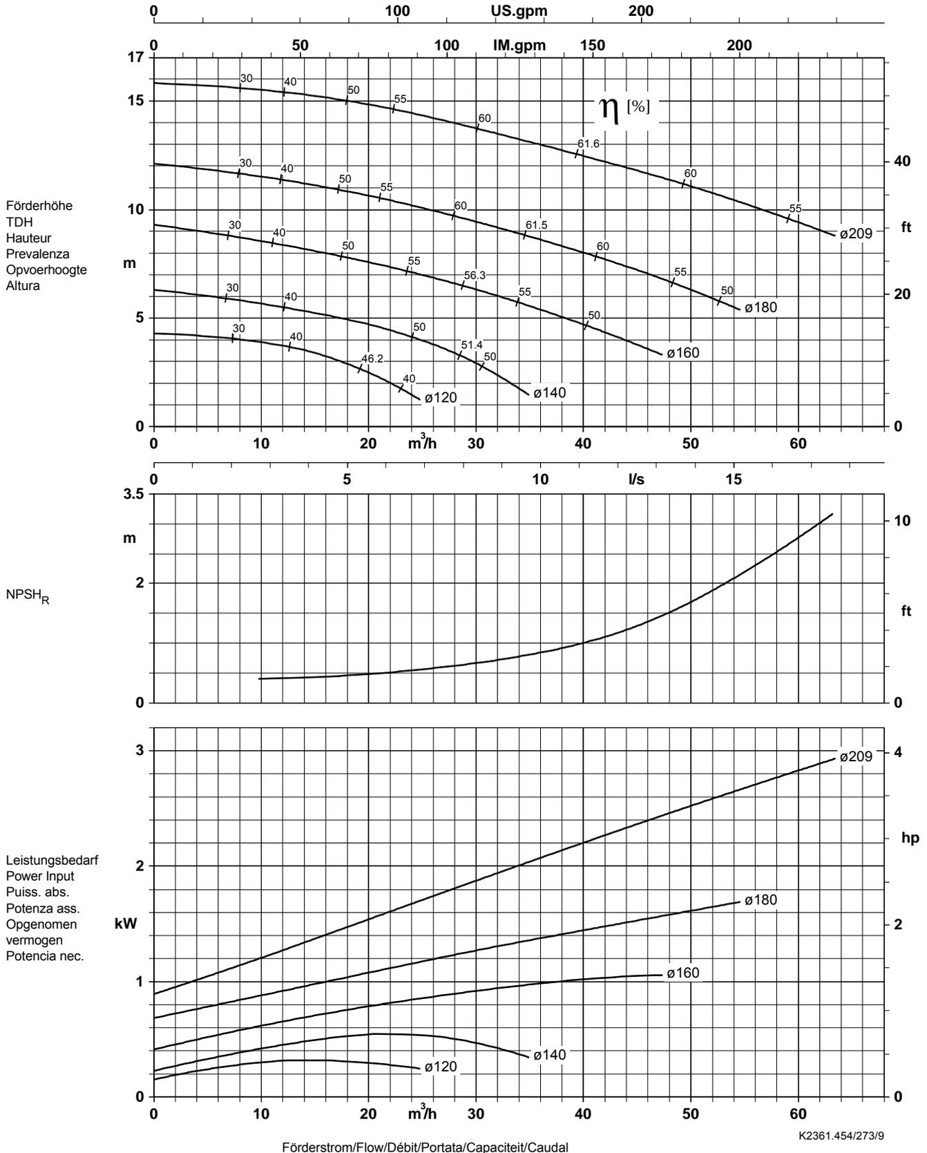
Laufradaustrittsbreite/Impeller outlet width/Largeur à la sortie de la roue 34 x 34 mm
