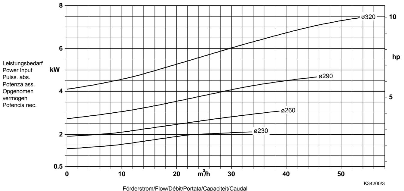
Laufradaustrittsbreite/Impeller outlet width/Largeur à la sortie de la roue 56 x 15 mm
