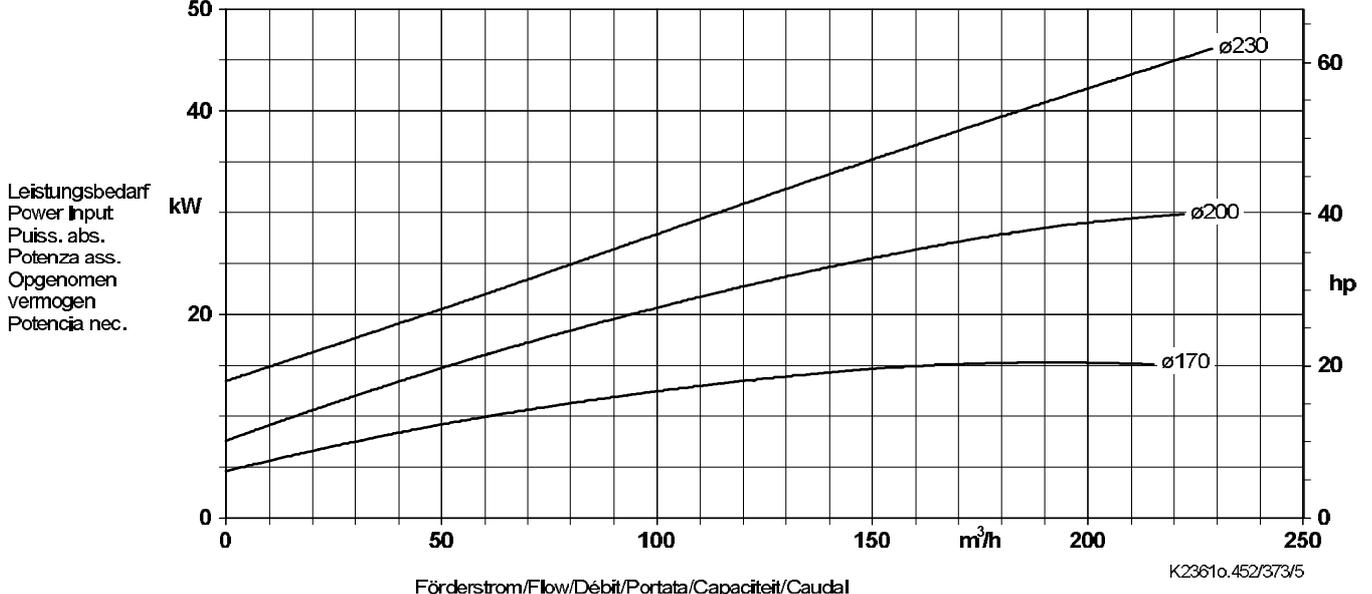
Lauftradaustrittsbreite / Impeller outlet width / Largeur à la sortie de la roue 36,0 mm
