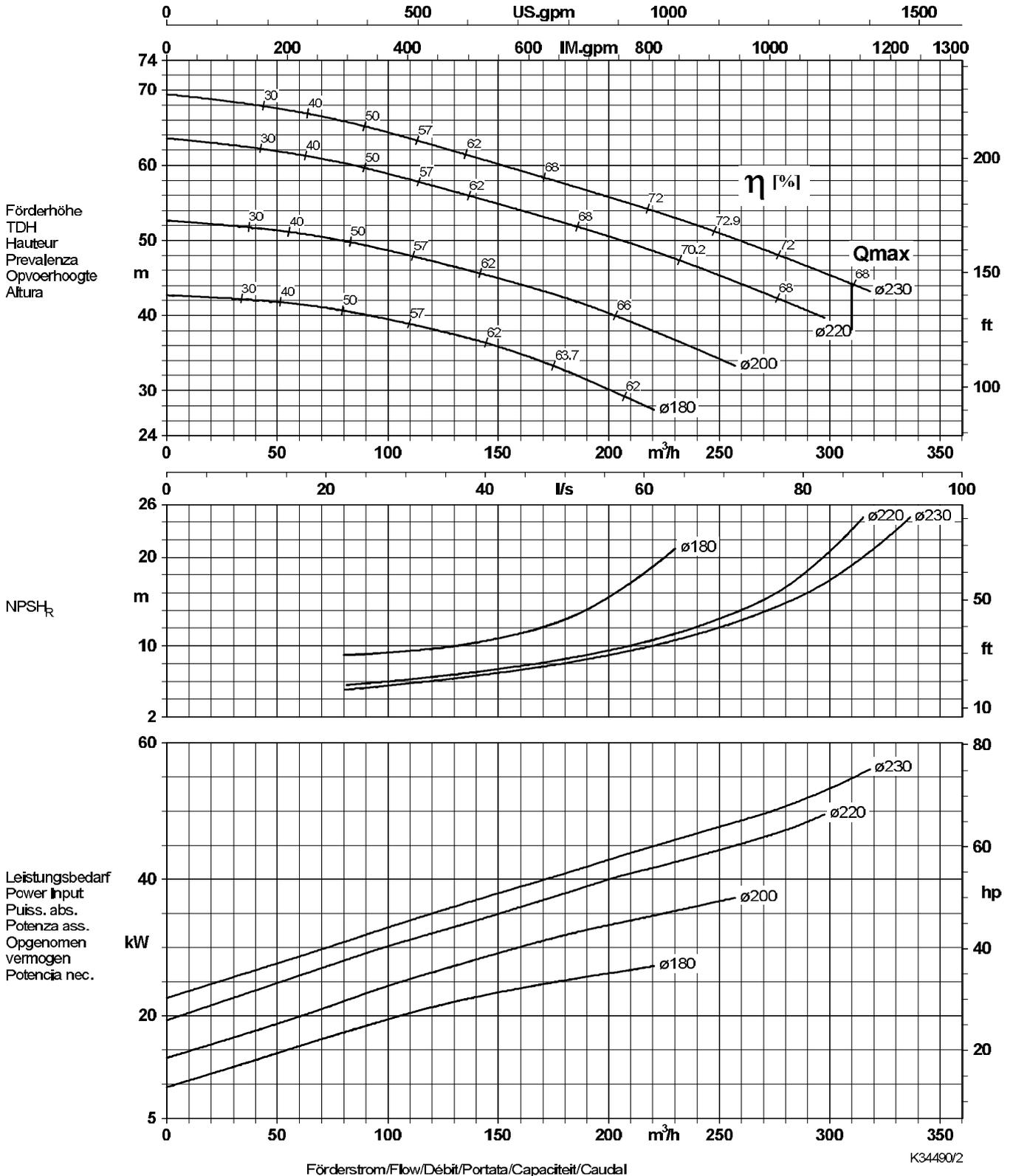
Lauftradaustrittsbreite/Impeller outlet width/Largeur à la sortie de la roue 70 x 50 mm
