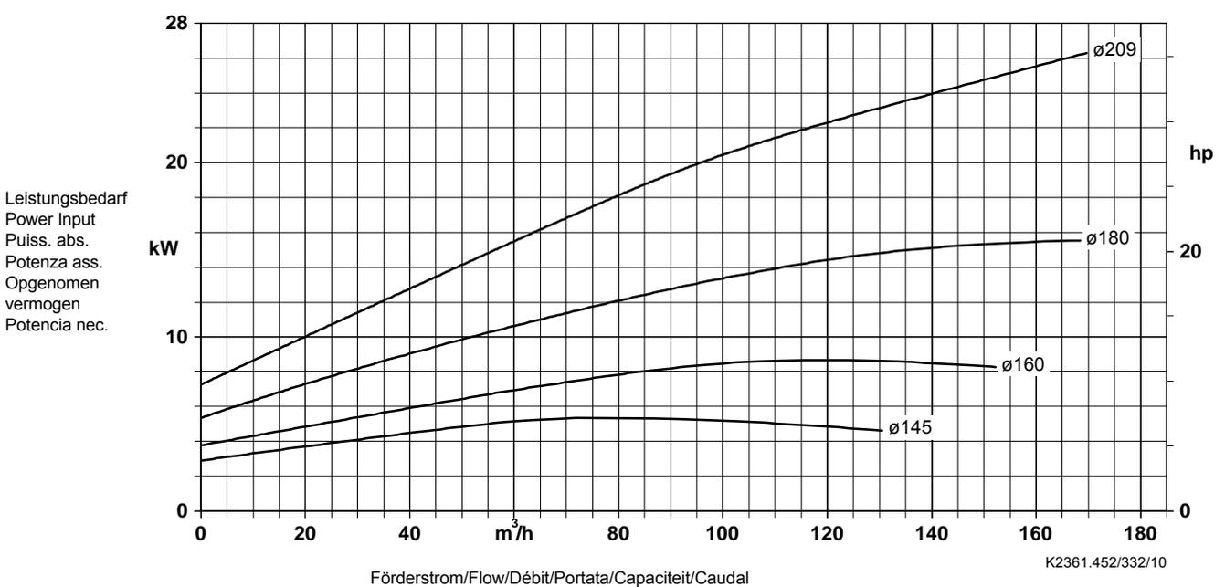
Laufradaustrittsbreite/Impeller outlet width/Largeur à la sortie de la roue 46 x 46 mm
