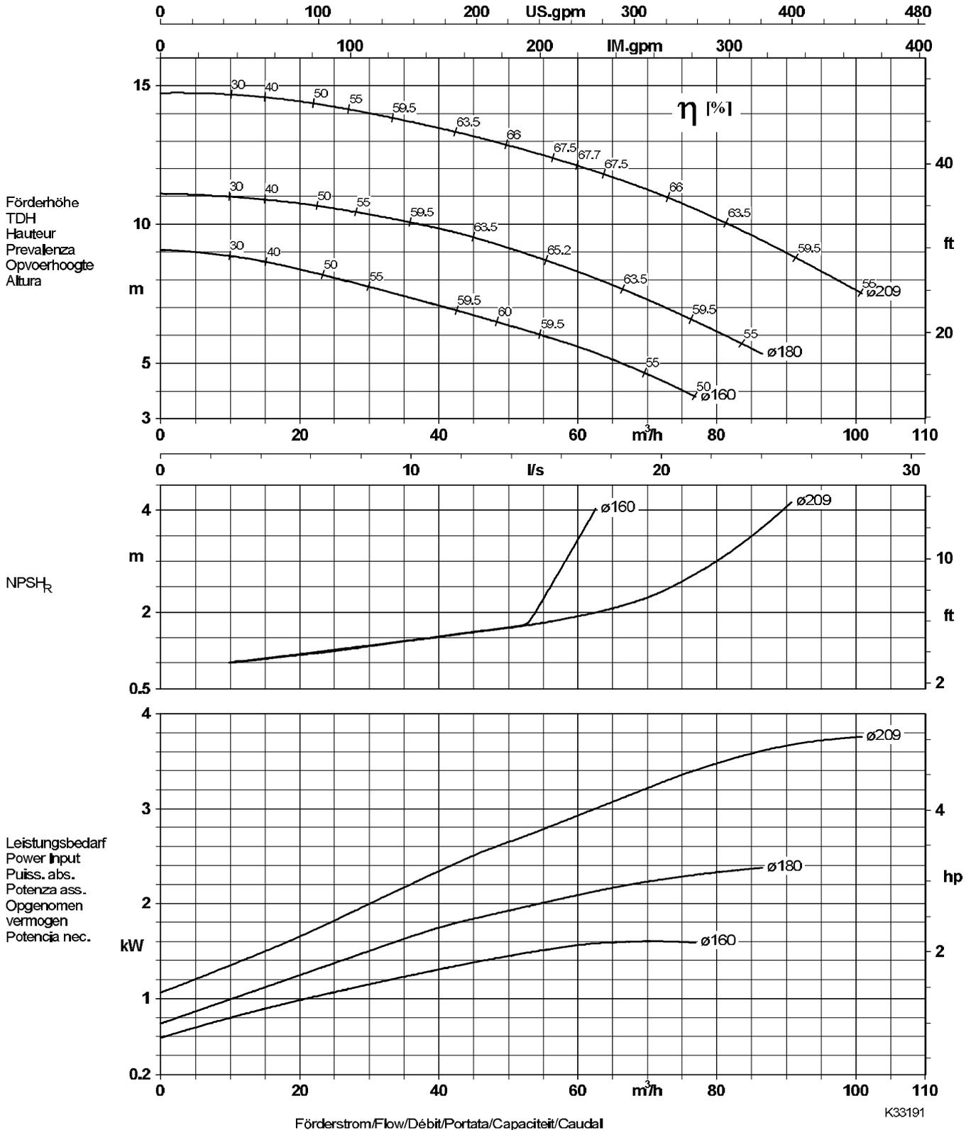
Lauf rad austrittsbreite / Impeller outlet width / Largeur à la sortie de la roue 30,0 mm
