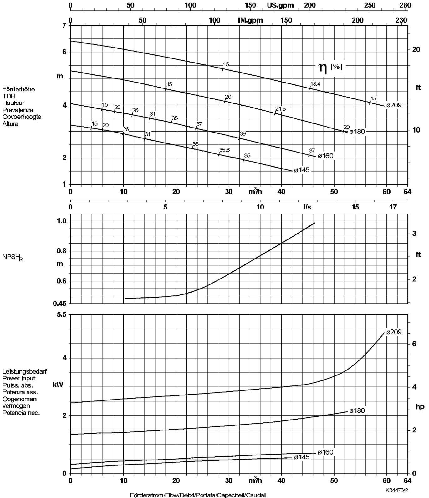
Lauftradaustrittsbreite / Impeller outlet width / Largeur à la sortie de la roue 45 x 45 mm
