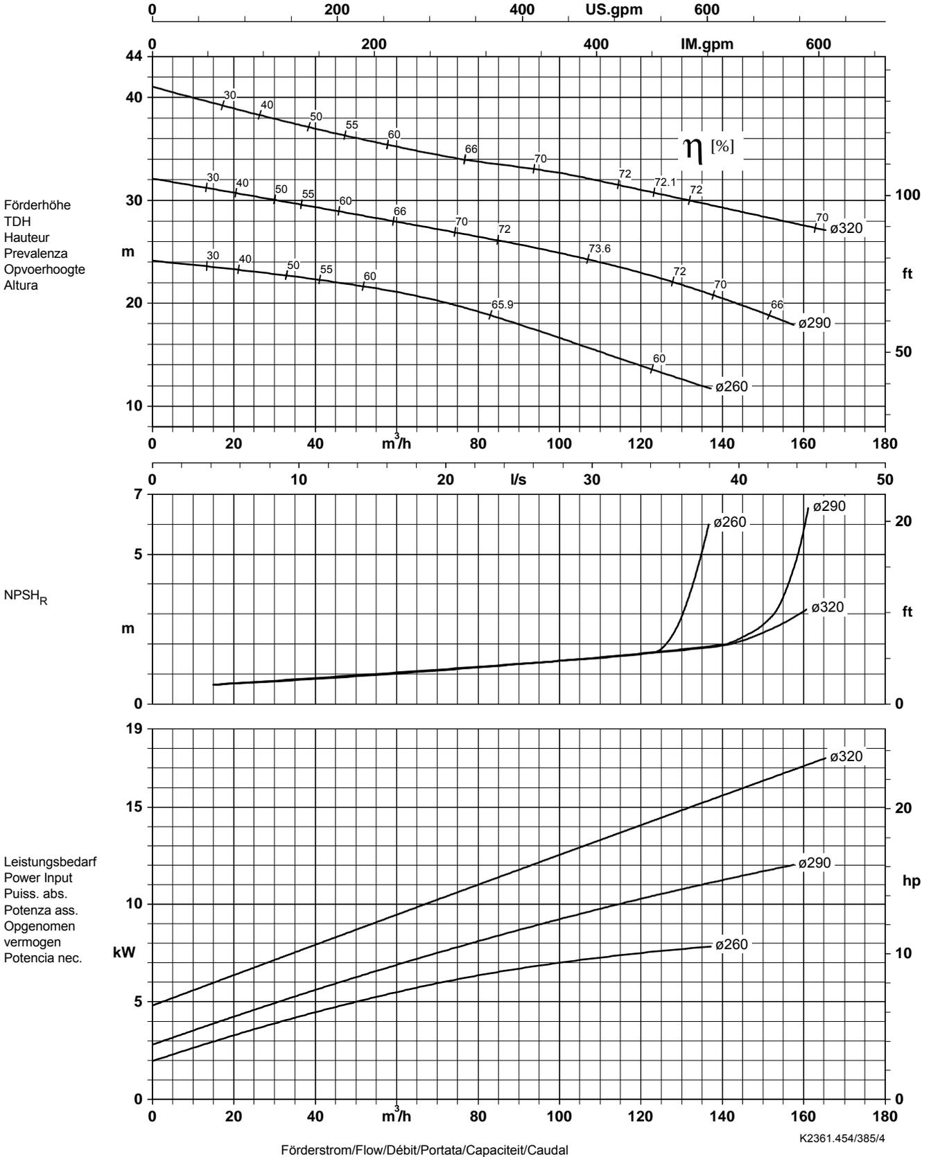
Lauftradaustrittsbreite/Impeller outlet width/Largeur à la sortie de la roue 49 x 44 mm
