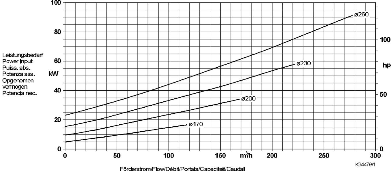
Laufradaustrittsbreite/Impeller outlet width/Largeur à la sortie de la roue 80 x 50 mm
