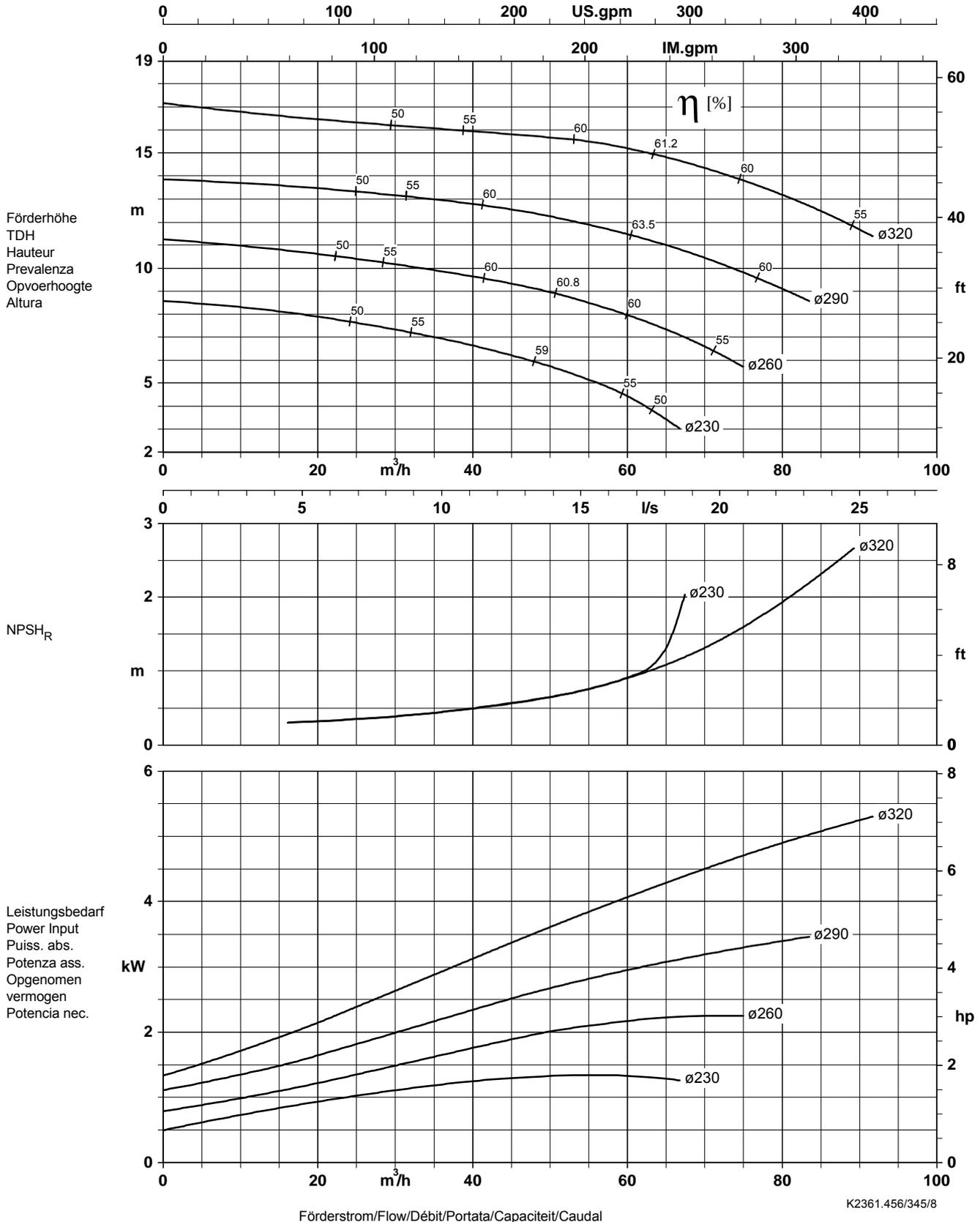
Lauf rad austrittsbreite/Impeller outlet width/Largeur à la sortie de la roue 42 x 42 mm
