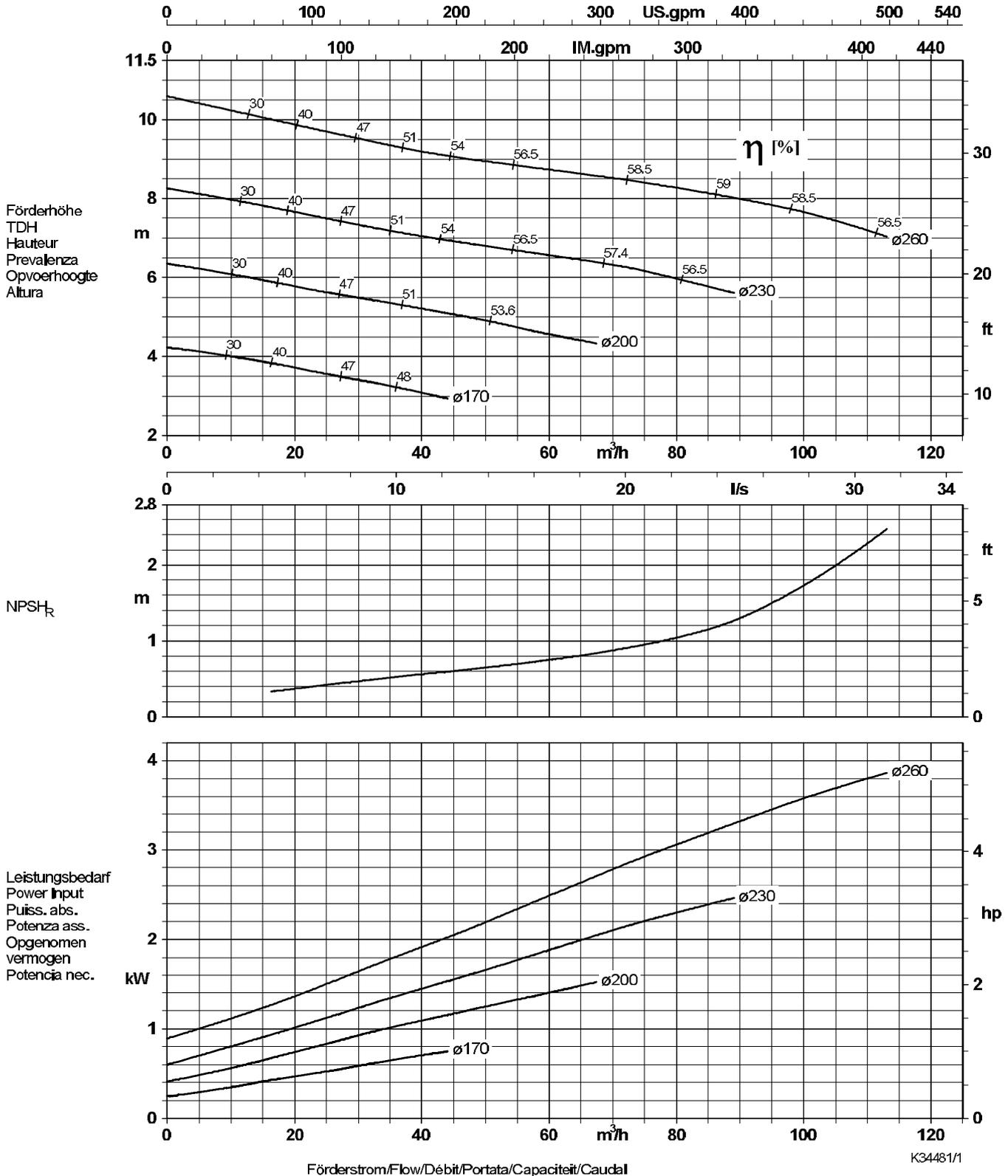
Lauf rad austrittsbreite / Impeller outlet width / Largeur à la sortie de la roue 80 x 50 mm
