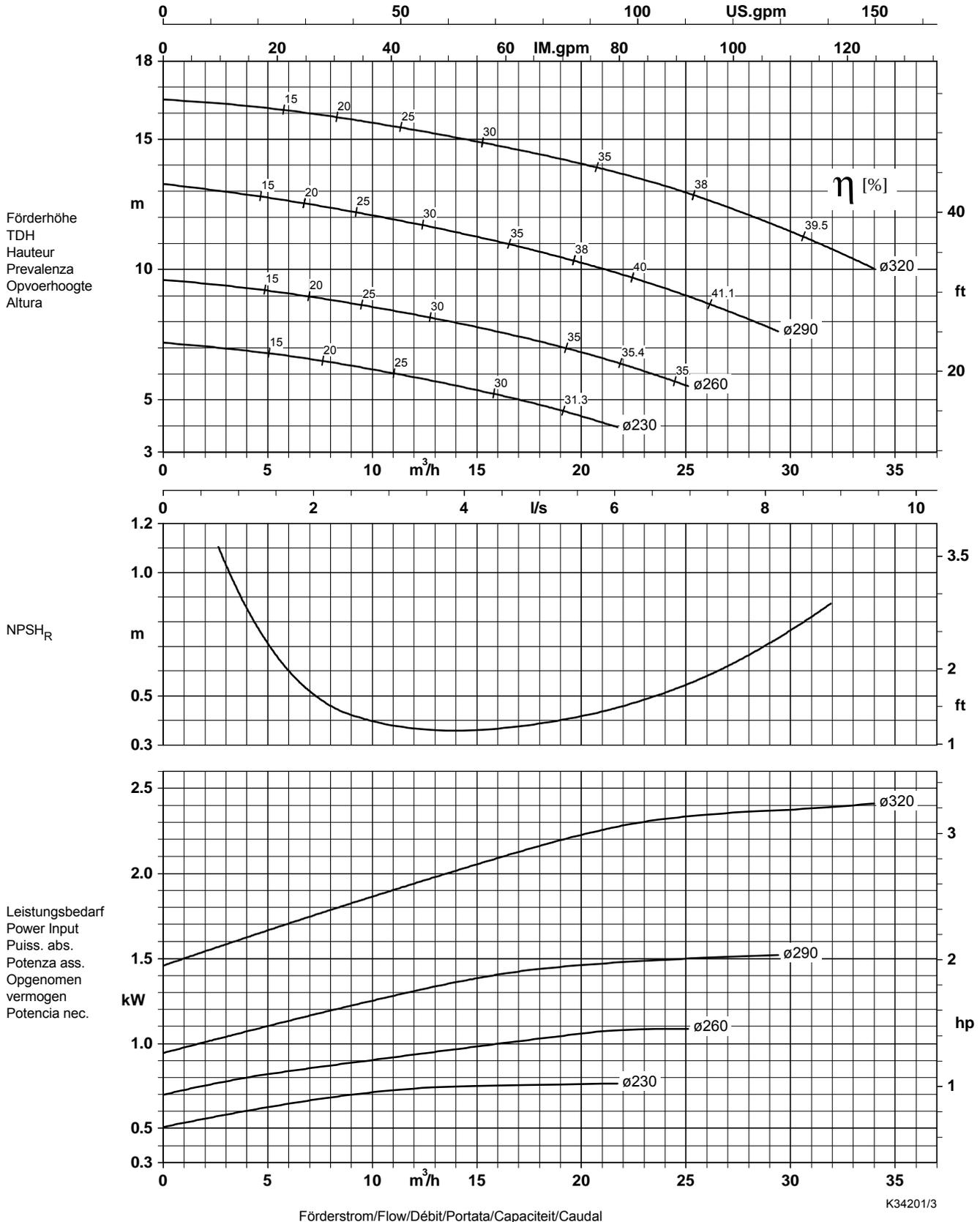
Laufradaustrittsbreite/Impeller outlet width/Largeur à la sortie de la roue 56 x 15 mm
