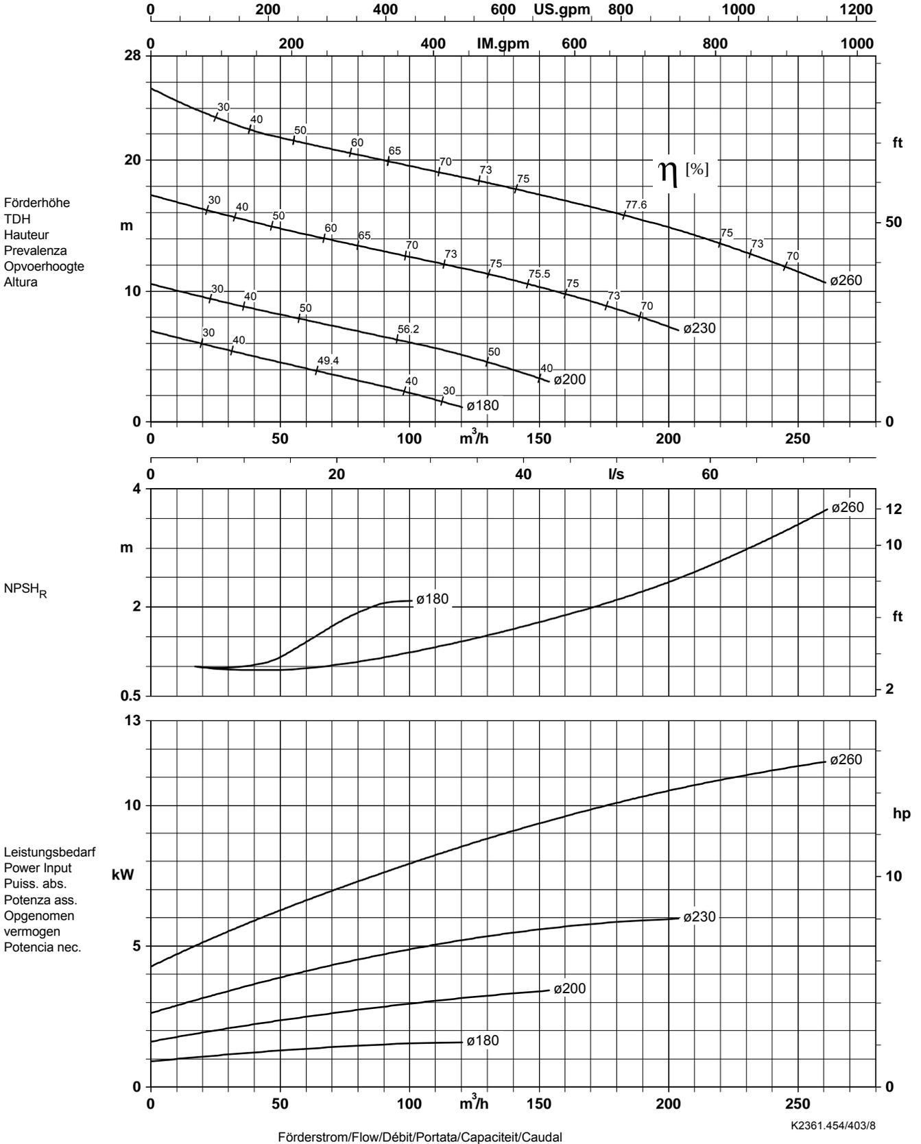
Laufradaustrittsbreite/Impeller outlet width/Largeur à la sortie de la roue 60 x 60 mm
