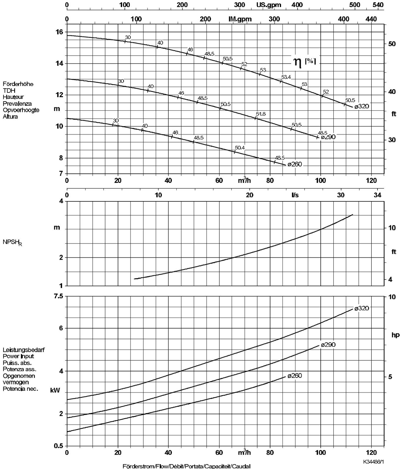
Lauf rad austrittsbreite/Impeller outlet width/Largeur à la sortie de la roue 50 x 30 mm
