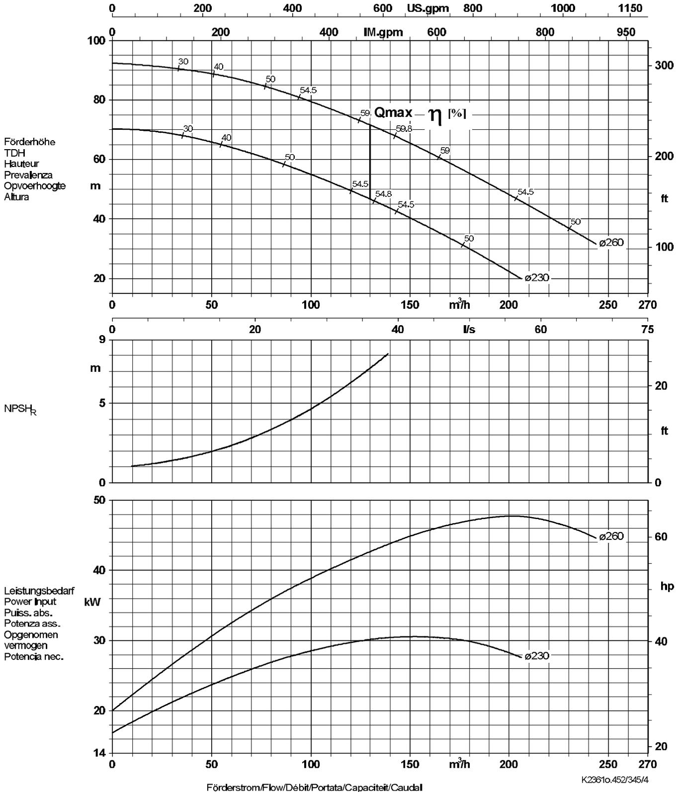
Laufradaustrittsbreite / Impeller outlet width / Largeur à la sortie de la roue 25,0 mm
