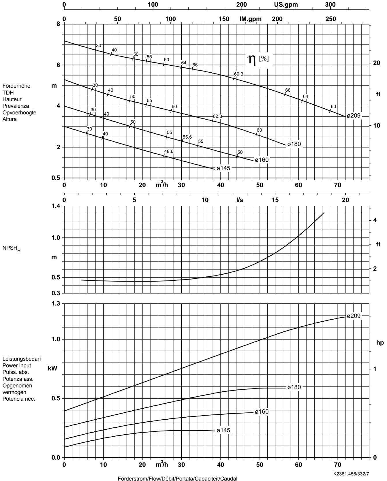
Laufradaustrittsbreite/Impeller outlet width/Largeur à la sortie de la roue 46 x 46 mm
