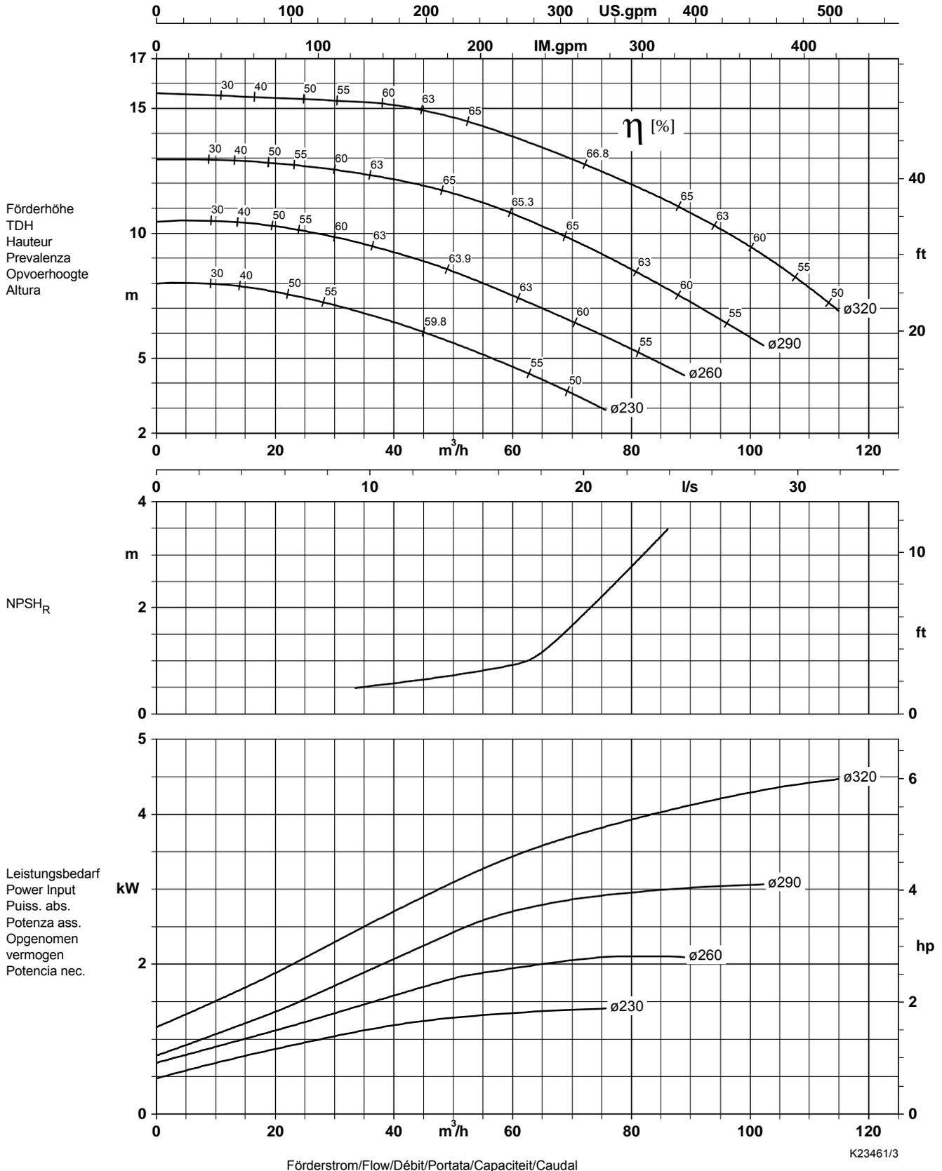
Lauf rad austrittsbreite/Impeller outlet width/Largeur à la sortie de la roue 15,0 mm
