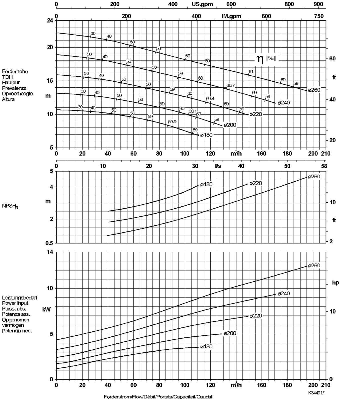
Laufradaustrittsbreite/Impeller outlet width/Largeur à la sortie de la roue 70 x 50 mm
