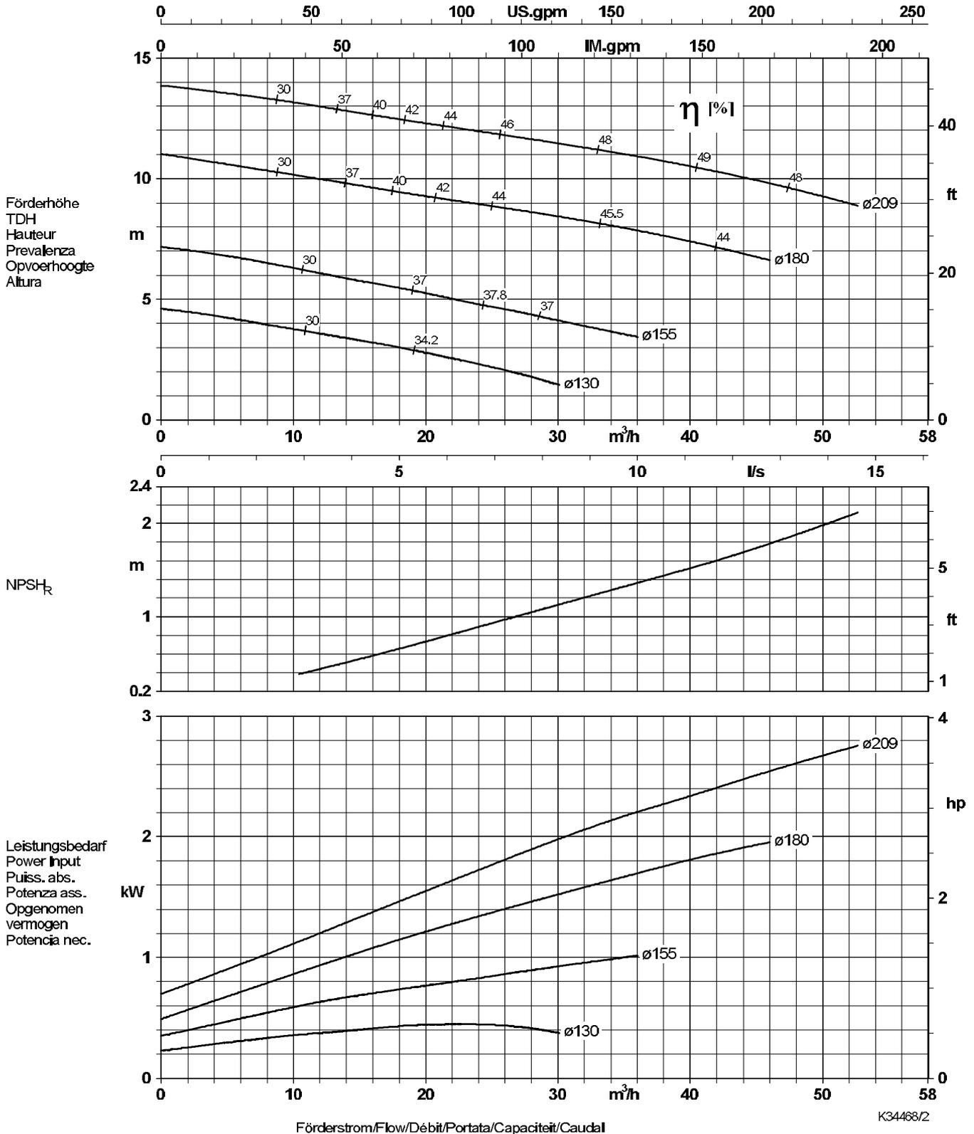
Laufradaustrittsbreite / Impeller outlet width / Largeur à la sortie de la roue 45 x 49 mm
