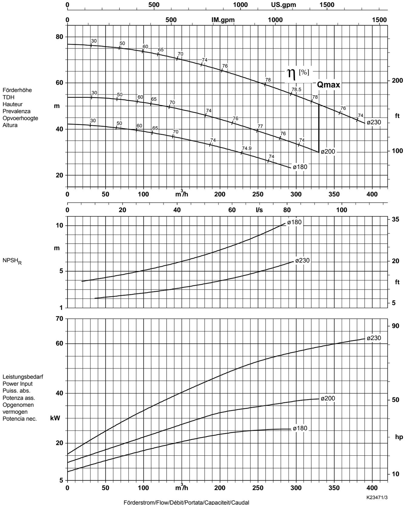
Lauf rad austrittsbreite/Impeller outlet width/Largeur à la sortie de la roue 28,0 mm
