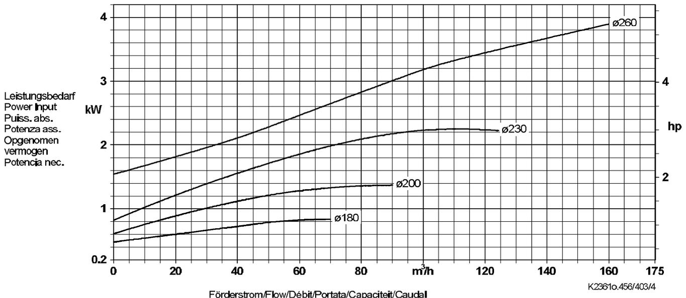
Lauf rad austrittsbreite / Impeller outlet width / Largeur à la sortie de la roue 50,0 mm
