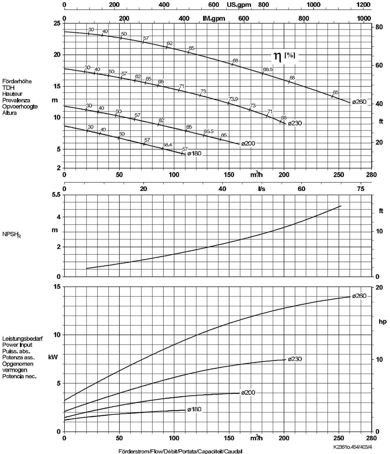
Lauf rad austrittsbreite / Impeller outlet width / Largeur à la sortie de la roue 50,0 mm
