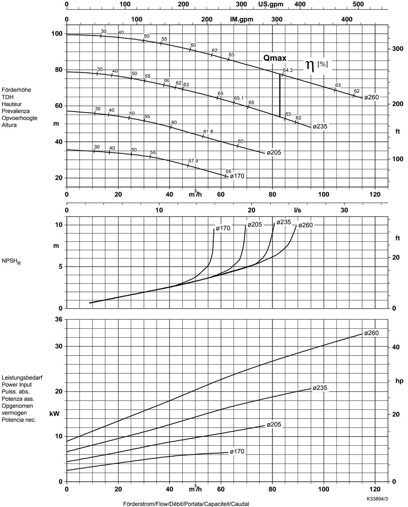
Lauftradaustrittsbreite/Impeller outlet width/Largeur à la sortie de la roue 28 x 15 mm
