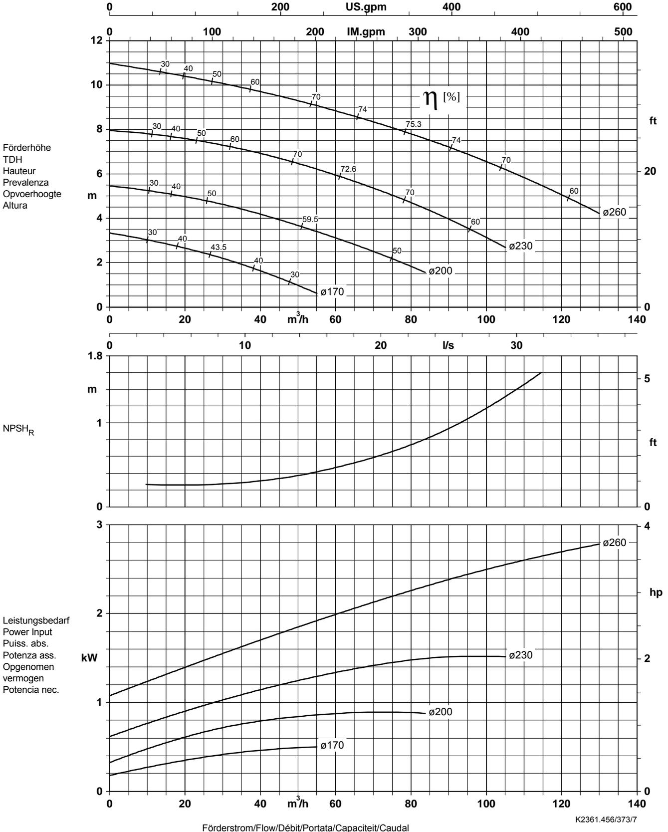
Lauf rad austrittsbreite / Impeller outlet width / Largeur à la sortie de la roue 50 x 50 mm
