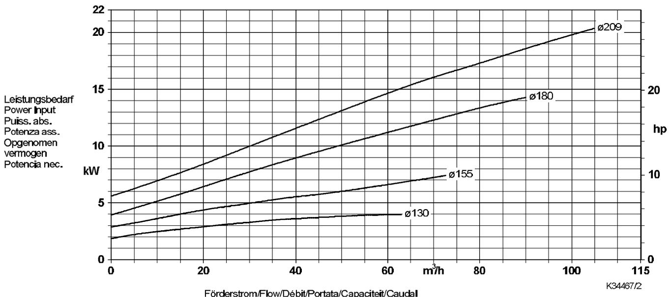
Lauf rad austrittsbreite / Impeller outlet width / Largeur à la sortie de la roue 45 x 49 mm
