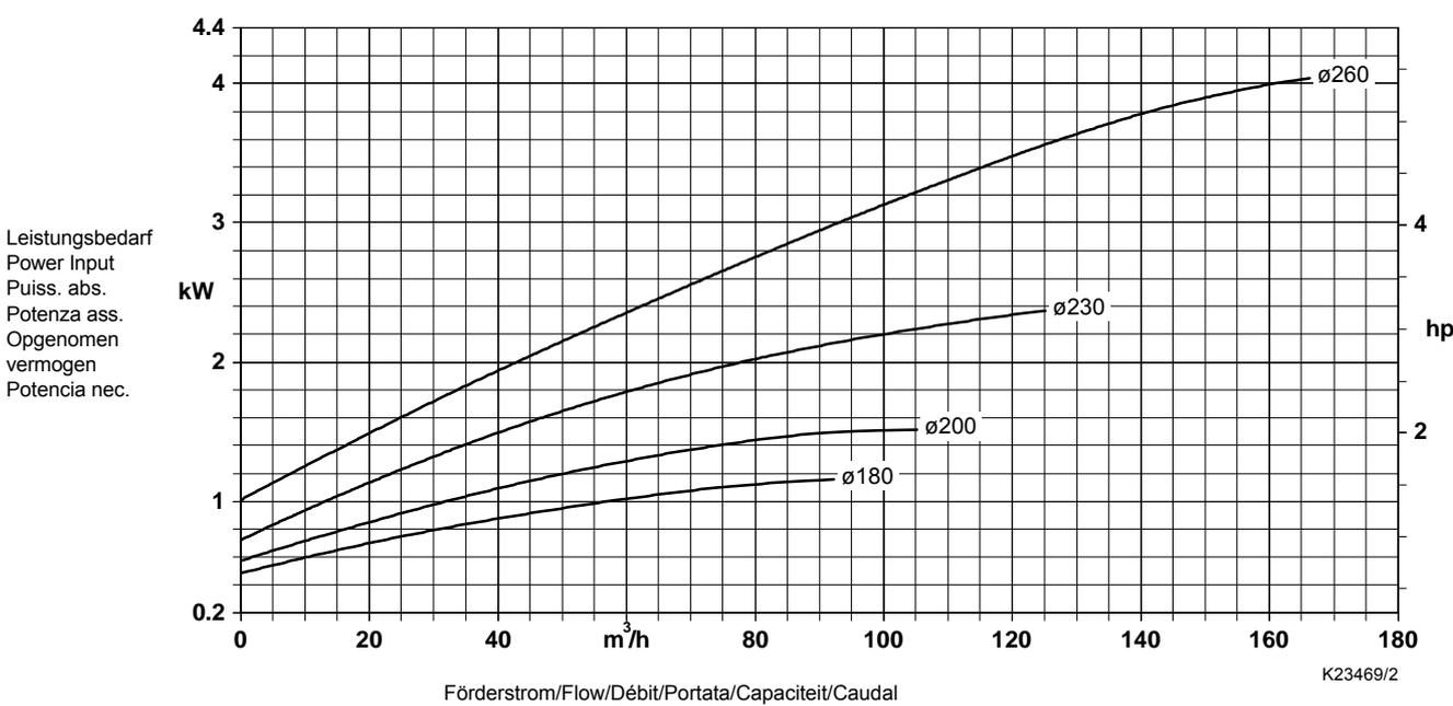
Lauf rad austrittsbreite / Impeller outlet width / Largeur à la sortie de la roue 28,0 mm
