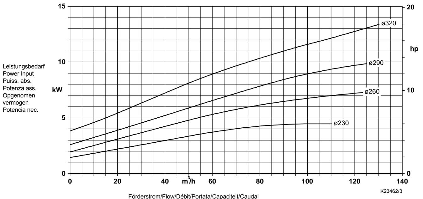
Lauf rad austrittsbreite / Impeller outlet width / Largeur à la sortie de la roue 15,0 mm
