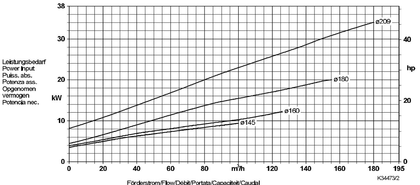
Lauf rad austrittsbreite / Impeller outlet width / Largeur à la sortie de la roue 45 x 45 mm
