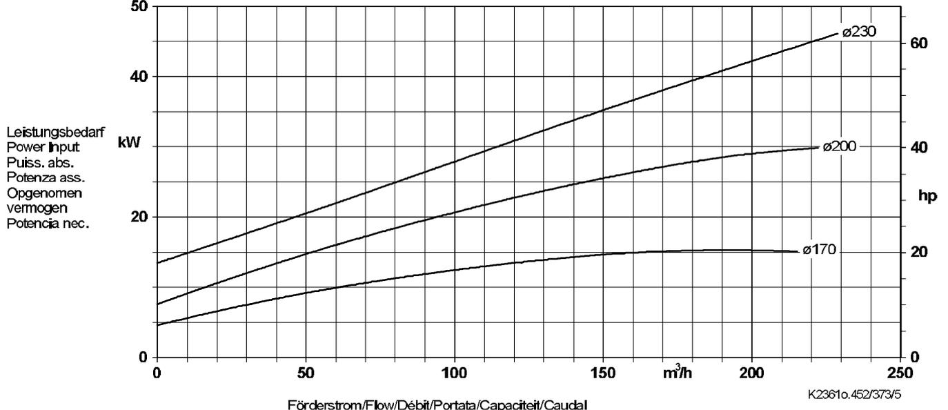
Laufradaustrittsbreite/Impeller outlet width/Largeur à la sortie de la roue 36,0 mm
