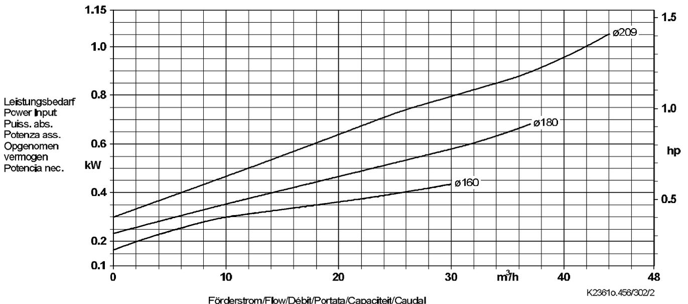
Laufradaustrittsbreite/Impeller outlet width/Largeur à la sortie de la roue 30,0 mm
