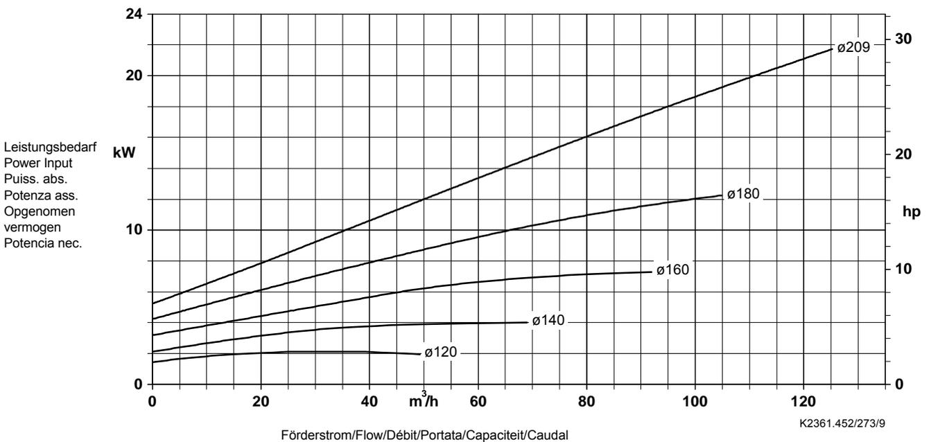
Laufradaustrittsbreite/Impeller outlet width/Largeur à la sortie de la roue 34 x 34 mm
