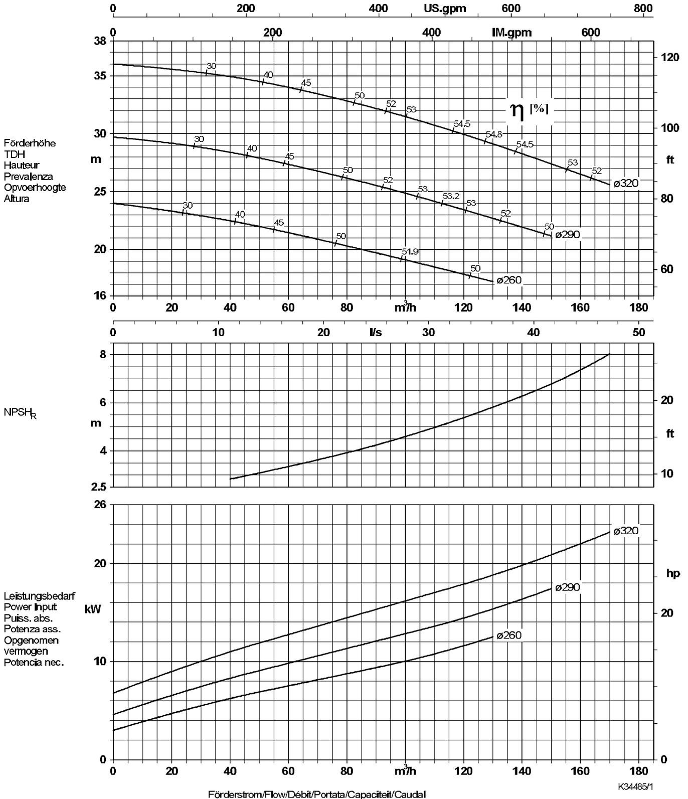
Lauftradaustrittsbreite/Impeller outlet width/Largeur à la sortie de la roue 50 x 30 mm
