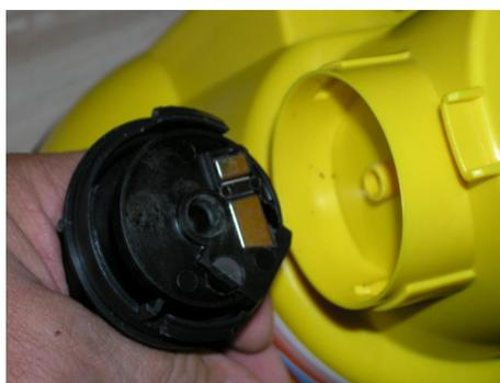
**III. 7:** Démontage de la commande automatique
