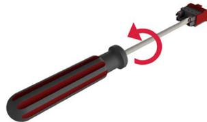
4. Die jetzt im Klemmenblock steckenden Zapfen mit Hilfe eines Schlitzschraubendrehers in eine der 4 möglichen Positionen bringen.
