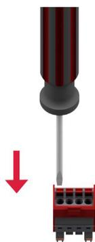
2. Federklemme mit dem Schraubendreher nach unten drücken, Kabel oder Sensoranschluss in das betreffende Loch einführen und Federklemme wieder lösen.
