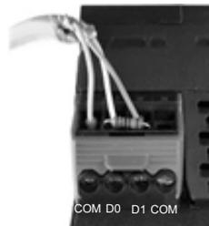
**Abb. 10:** Klemme Felddbusmodul (Modbus RTU), Abschlusswiderstand
