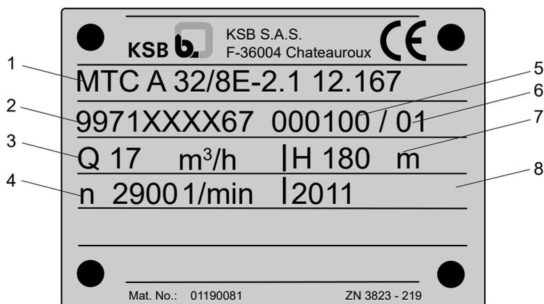
Fig. 5: Targhetta costruttiva (esempio) Multitec
