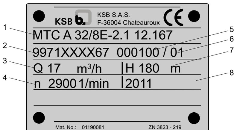
Fig. 5: Placa de características (ejemplo) Multitec
