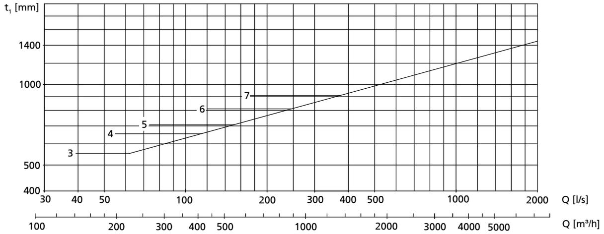
Abb. 13: Diagramm für Mindestwasserstand, Motorversion UN, XN
