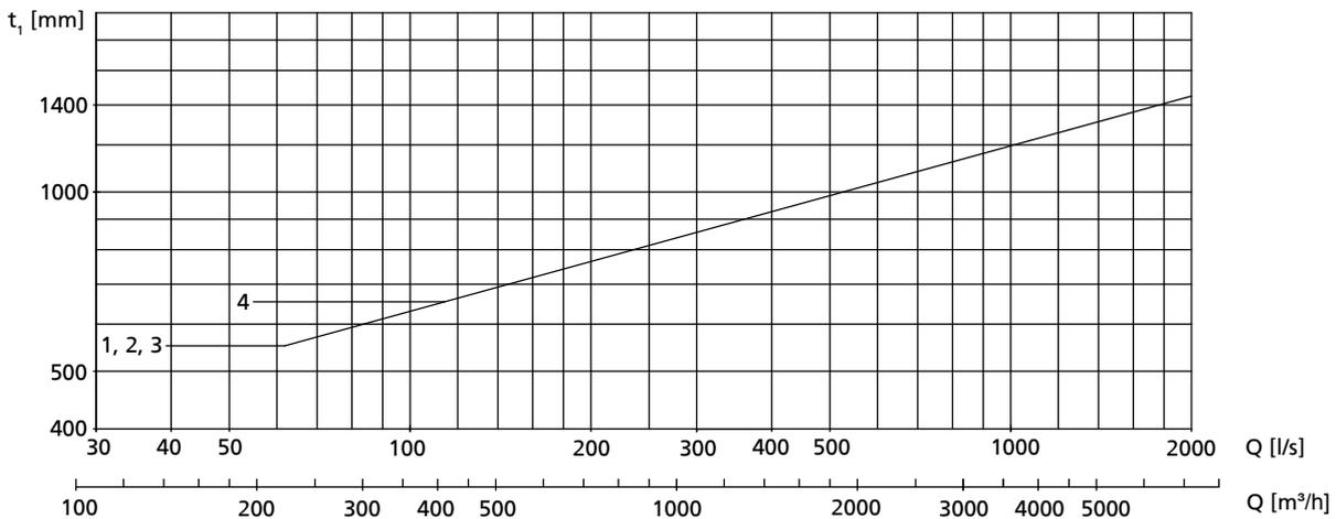
Abb. 8: Diagramm für Mindestwasserstand, Motorversion UE, XE
