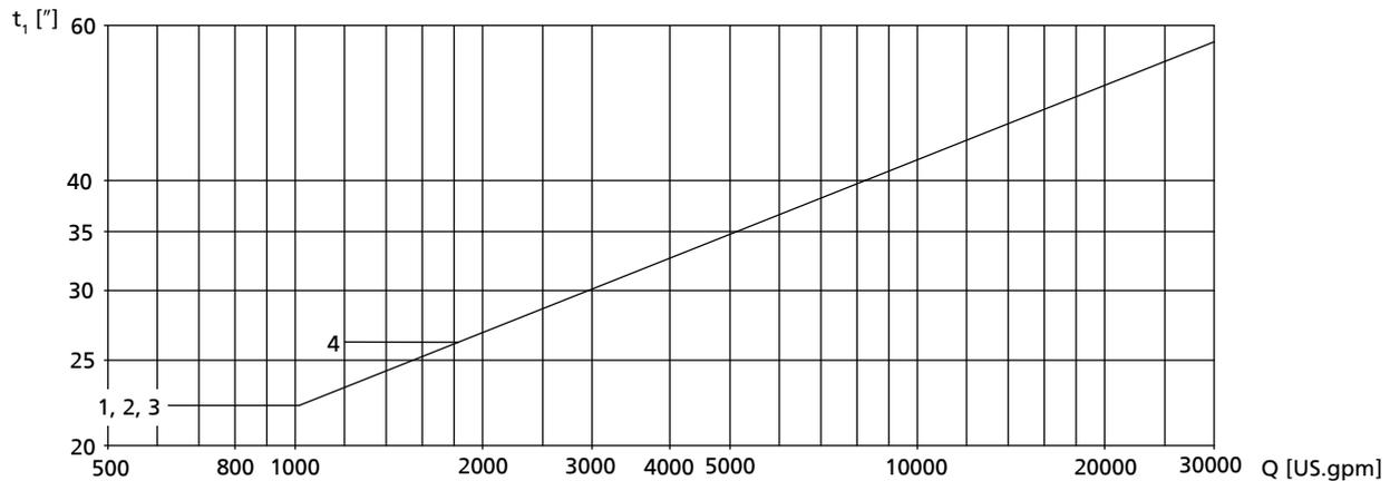
Abb. 2: Diagramm für Mindestwasserstand, Motorversion UE, XE
