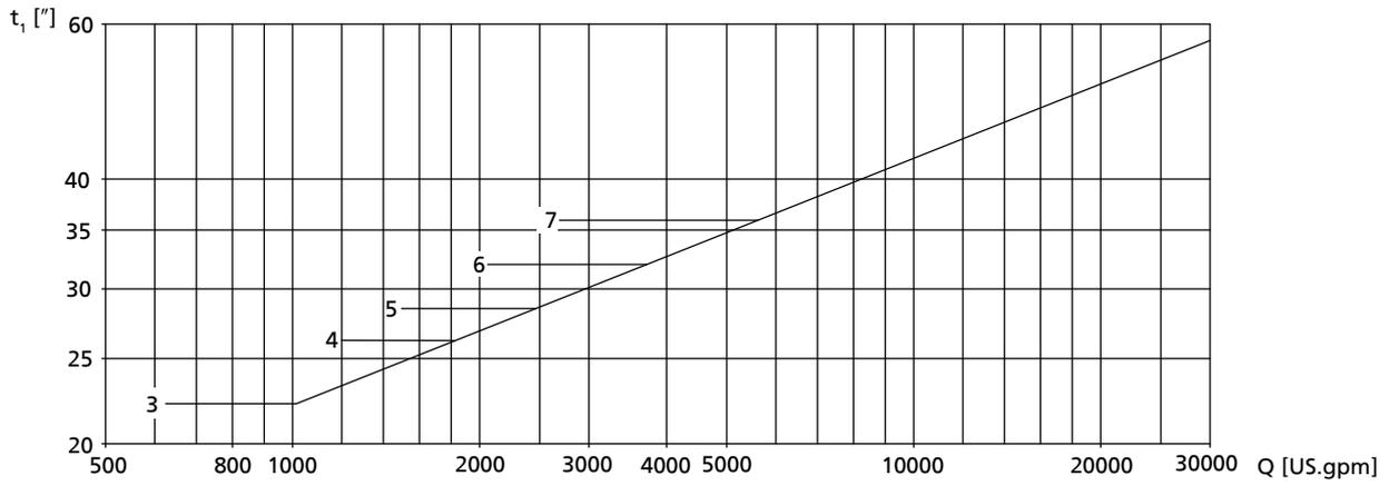
Abb. 5: Diagramm für Mindestwasserstand, Motorversion UN, XN
