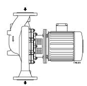
**Abb. 8:** Horizontaler Einbau, Durchflussrichtung von oben nach unten Spiralgehäuse oder Einschubeinheit muss um 180° gedreht werden, damit der Klemmenkasten in der nach oben gerichteten Lage verbleibt.
