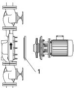
Abb. 10: Horizontaler Einbau mit Blindflansch (1 = Blindflansch, Zubehör)
