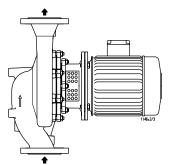
Abb. 7: Horizontaler Einbau, Durchflussrichtung von unten nach oben
