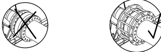
**Abb. 9:** Anschluss über Kompensatoren
