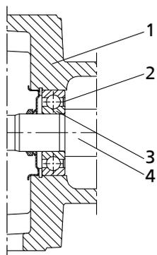
**III. 16: Montage des roulements à billes radiaux**
