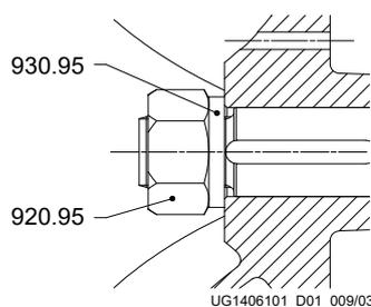
III. 26: Fixation de la roue WS 60.1
