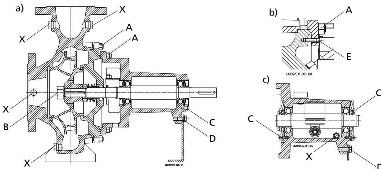
III. 20: Points de serrage de vis : version avec couvercle de corps vissé et lubrification à la graisse (a) et version avec couvercle de corps pincé (b) et lubrification à l'huile (c)
