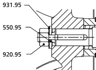
III. 25: Fixation de la roue WS\_25
