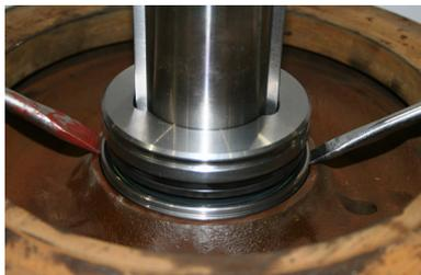
**Fig. 16:** Fijación de cierres mecánicos con palancas de hierro.
