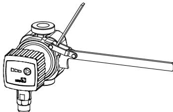
**Abb. 11:** Überwurfmutter lockern und anziehen
