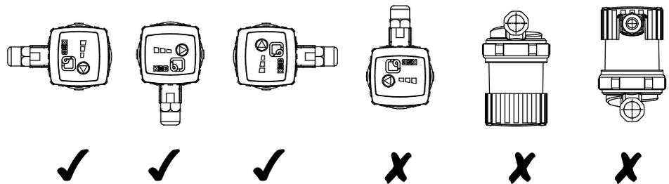
**Abb. 3:** Zulässige Einbaulagen Calio-Therm S NC
