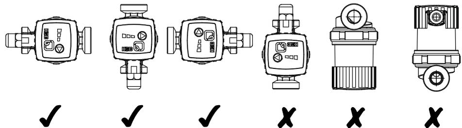
**Abb. 4:** Zulässige Einbaulagen Calio-Therm S NCV
