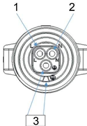
**Abb. 7:** Adern an den Kontakteinsatz anschließen
