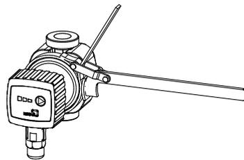
**Abb. 8:** Überwurfmutter lockern und anziehen
