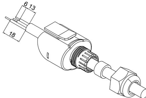
**Abb. 5:** Elektrische Leitung abisolieren [mm]
