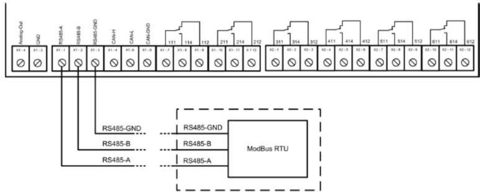
Fig. 9: Collegamento Modbus
