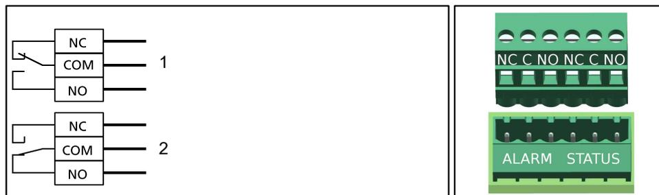
III. 15: Schéma de connexion (logique inversée inactive)
