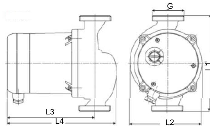
Abb. 3: Abmessungen Baugröße 25-70
